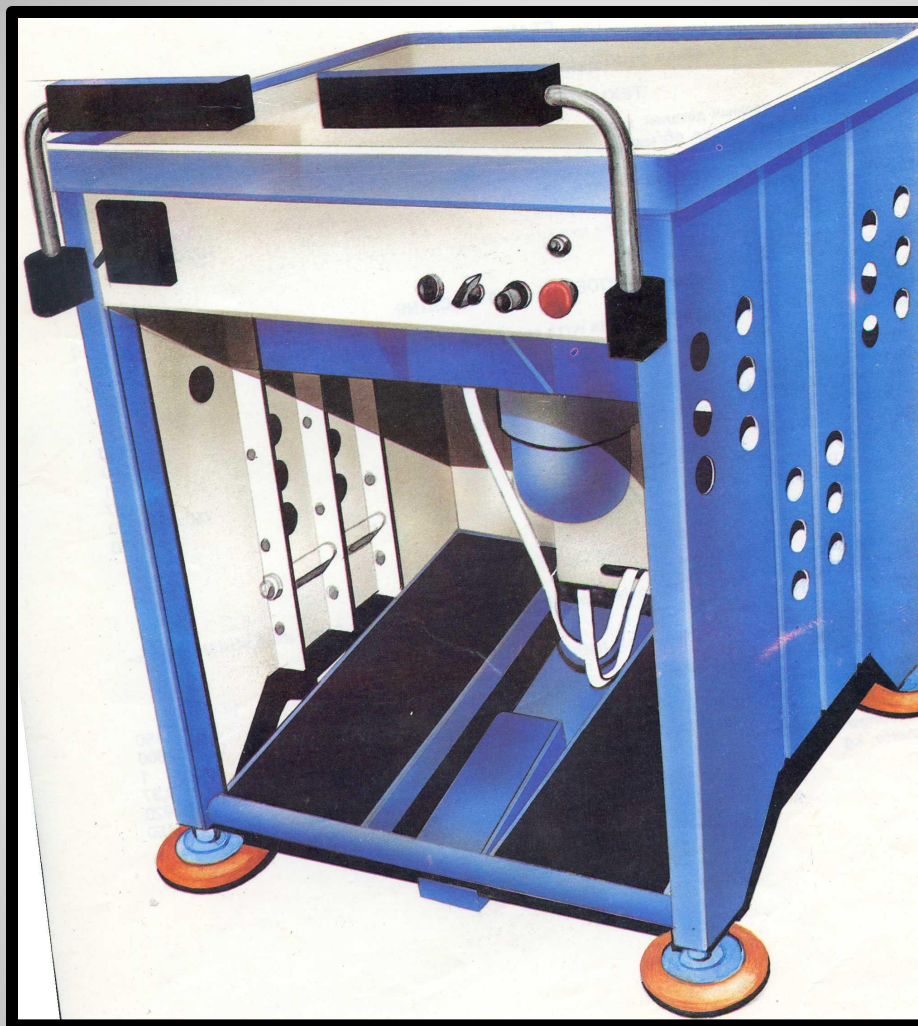
Станок для фасетирования наружных цилиндрических поверхностей СД-150
