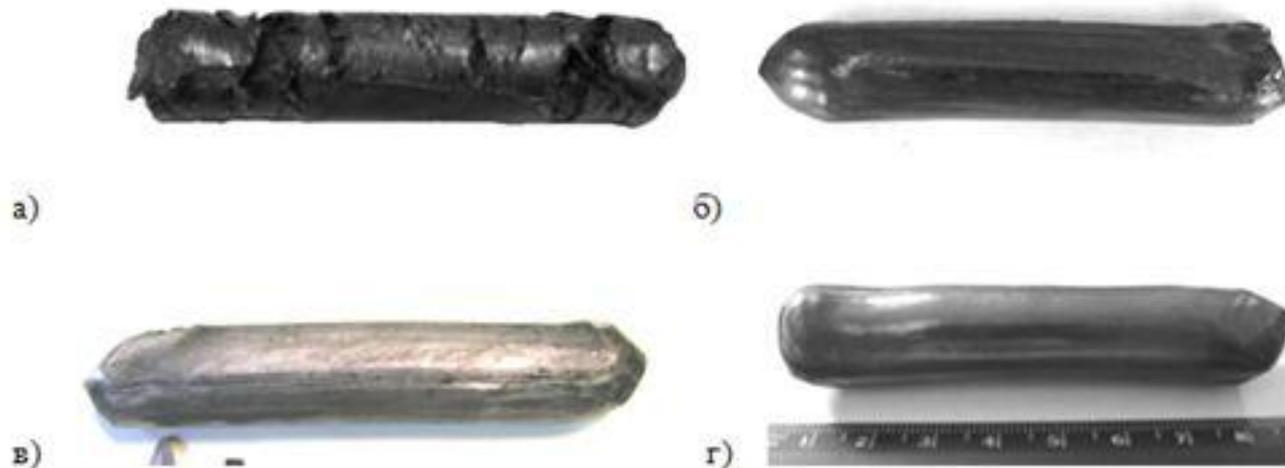
Рис. Общий вид образцов труднодеформируемых УМЗ материалов:
