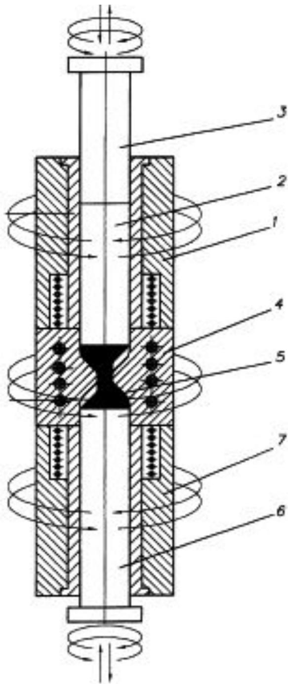
Верхний и нижний контейнеры, а также профилирующий инструмент имеют возможность вращения относительно друг друга в разных направлениях, нагрева и (или) охлаждения в различных сочетаниях.
