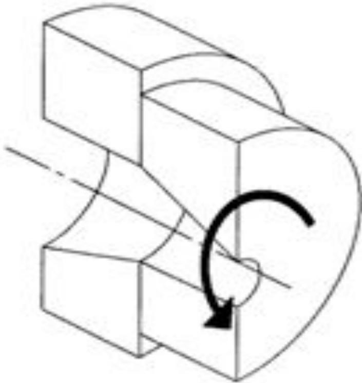
Деформация металла осуществляется за счет приложения тянущей силы через две последовательно расположенные конические волокни с одновременным вращением одной из волок
