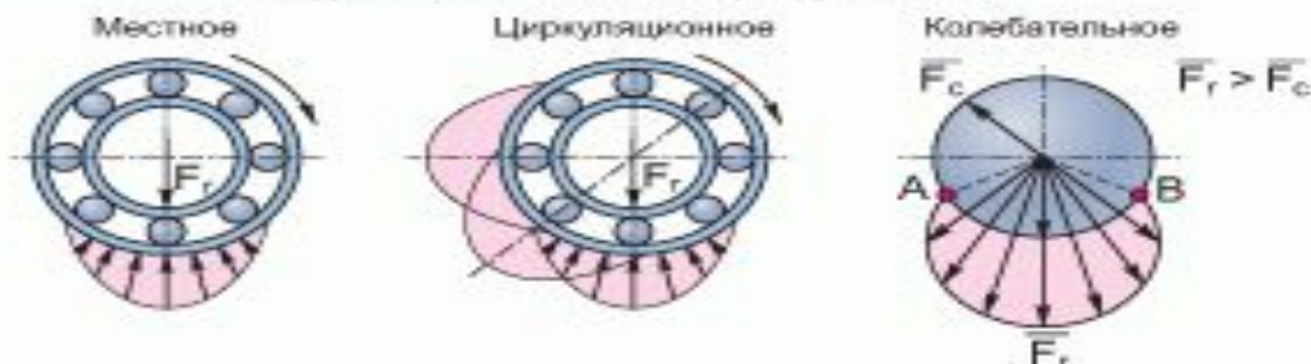
ВИДЫ НАГРУЖЕНИЯ КОЛЕЦ ПОДШИПНИКА
