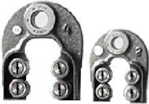
Рис.4.48. Резьбовые калибры скобы
