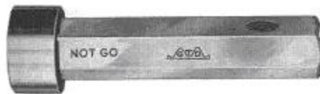
Рис. 3.13. Непроходной калибр-пробка (P-HE)
