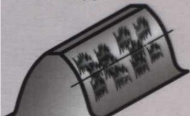
При высокой удельной нагрузке происходит разрыв масляной пленки, нагрев и схватывание сопряженных поверхностей с образованием микротрещин и следов задира в направлении скольжения зубьев.
