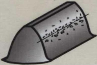
При работе **закрытой** зубчатой передачи в условиях **хорошей смазки** при циклическом нагружении у полюсной линии разрастаются микротрещины, что приводит к образованию оспинок, переходящих в раковины. На первое место выступают угол давления  $\alpha_w$  и коэффициент удельного давления  $p$ .
