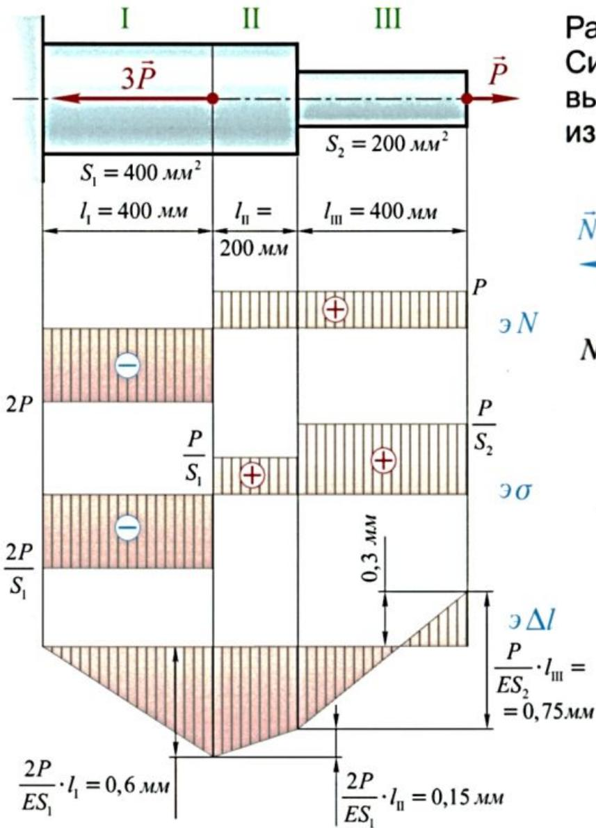
Рассматриваем равновесие отсеченных частей. Силу  $N$  полагаем положительной — растягивающей выделенный объем. Реальные значения определяются из уравнений равновесия:
