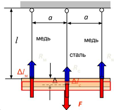
Реакции от медных стержней равны из-за симметрии системы.
