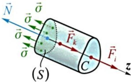
Растяжение-сжатие моделируется системой сил  $\{\bar{F}_i\}_n$ , приложенных в центрах тяжести поперечных сечений бруса, образующих его продольную ось  $z$ .
