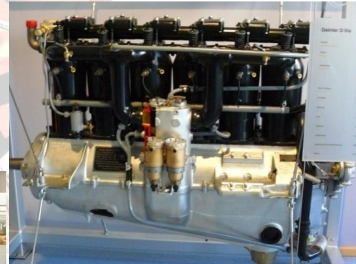
Рядный двигатель водяного охлаждения Daimler DIIIa (1917)
