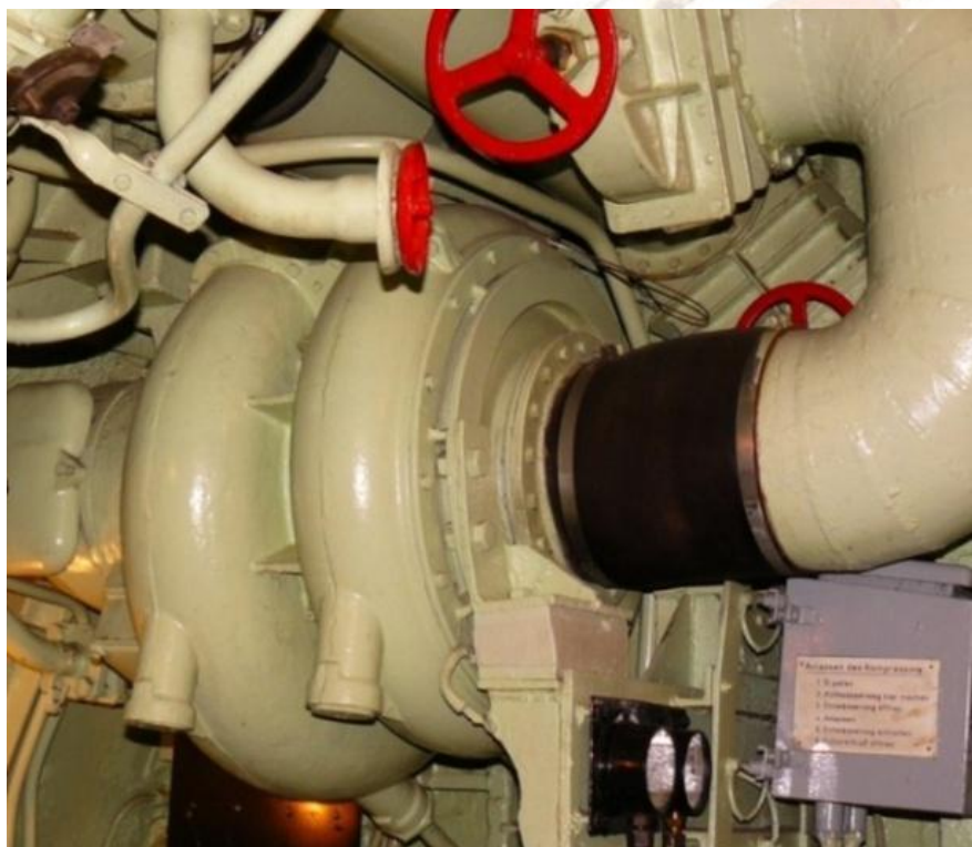
Турбоагнетатель немецкой подводной лодки XXI серии (1944)
