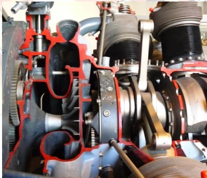
Центробежный нагнетатель звездообразного двигателя воздушного охлаждения BMW 805 (1943)
