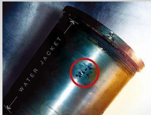
Износ наружной поверхности
