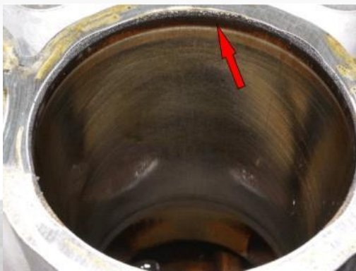
Износ посадочных поясков гильзы
