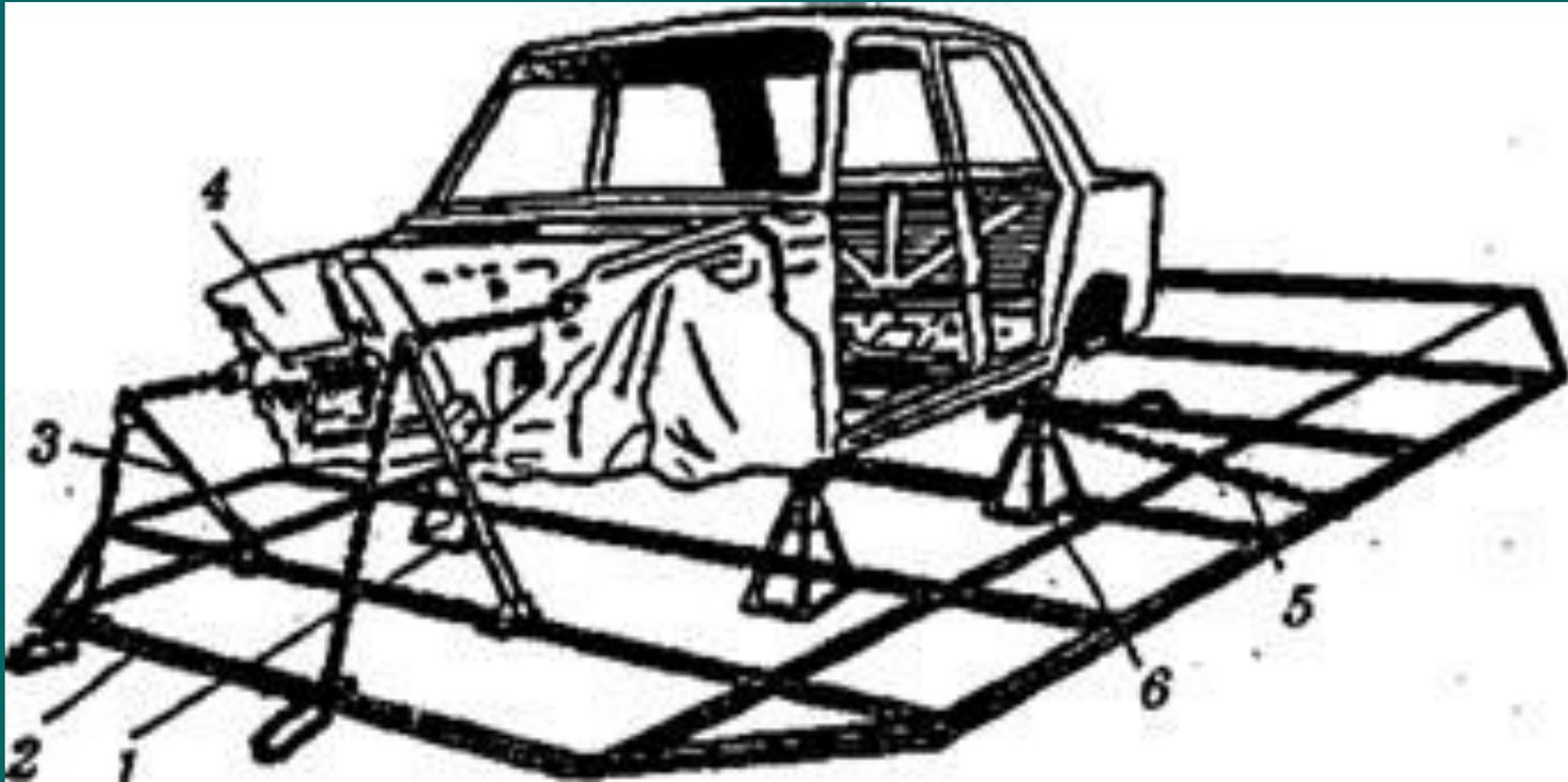
Стенд для правки кузова легкового автомобиля
