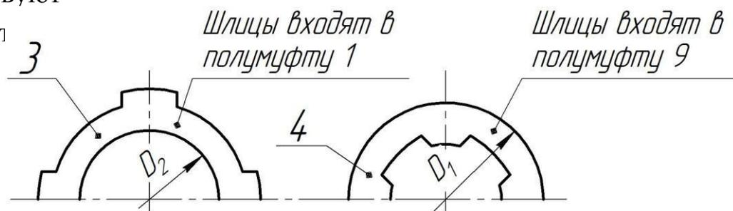
Рисунок 4.4.1. Конструкция наружных 3 и внутренних 4 дисков многодисковой муфты
