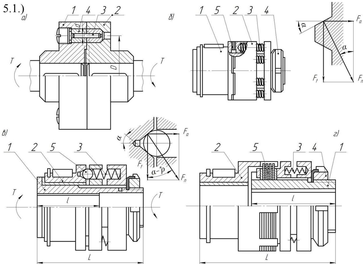
Рисунок 5.1. Предохранительные муфты
