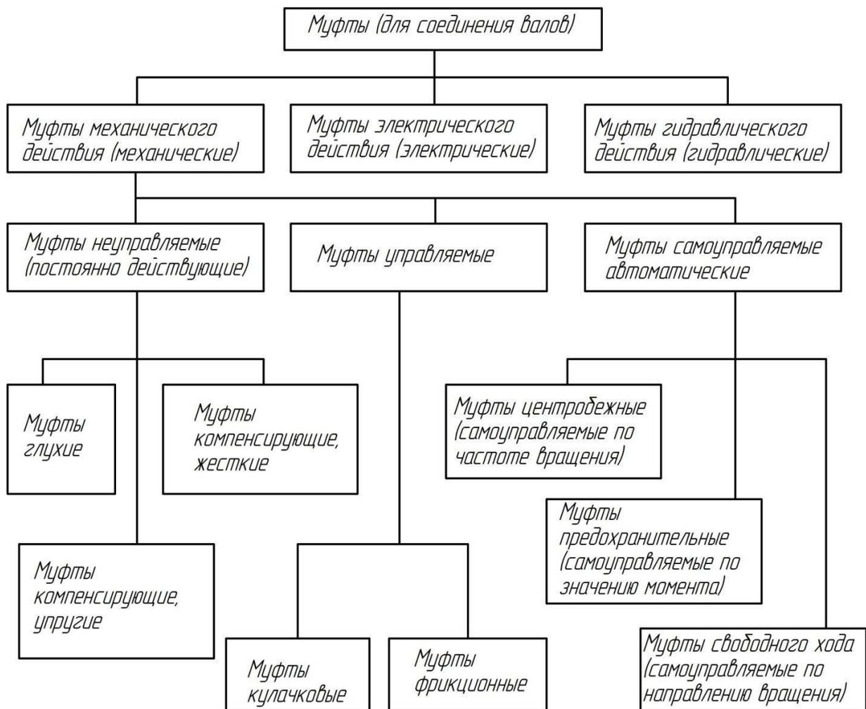
Многообразие существующих конструкций муфт затрудняет проведение точного рассмотрения всех их типов. В данной работе рассматривают наиболее распространенные в машиностроении муфты.
