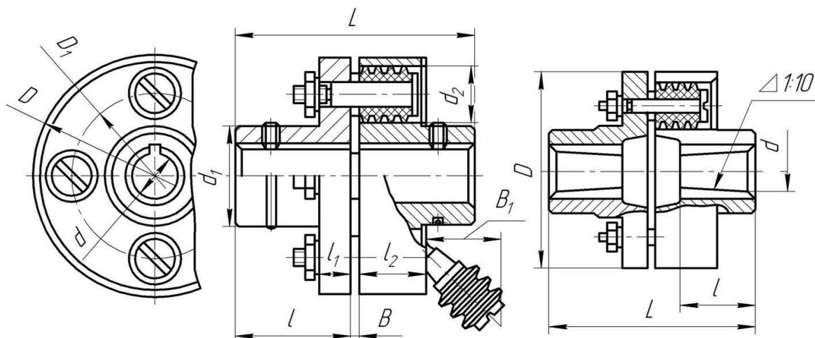
Тип I – цилиндрическое исполнение. Тип II – коническое отверстие
