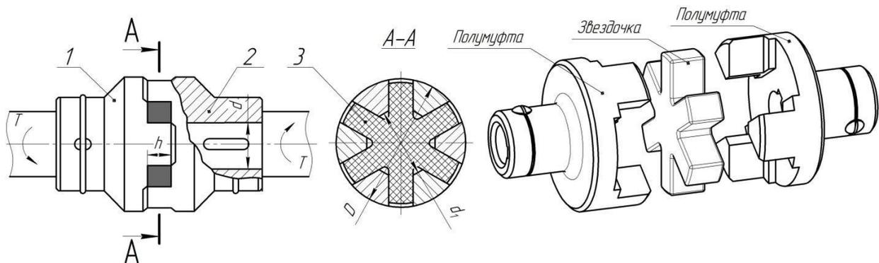
Рисунок 3.2. Муфта упругая со звездочкой
