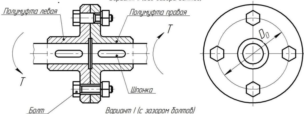
Рисунок 1.2. Фланцевая муфта
