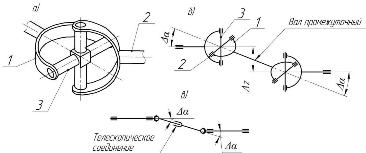
Рисунок 2.4. Муфты шарнирные
