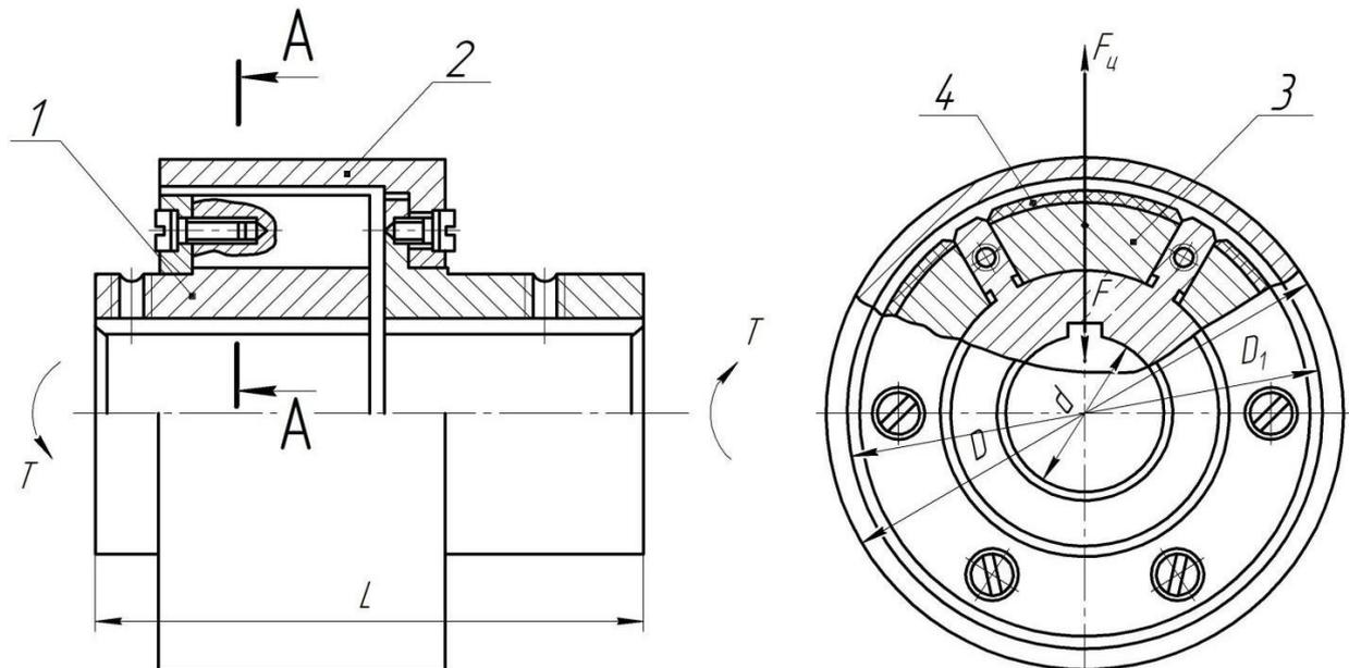
Рисунок 5.2. Конструкция простейшей центробежной муфты
