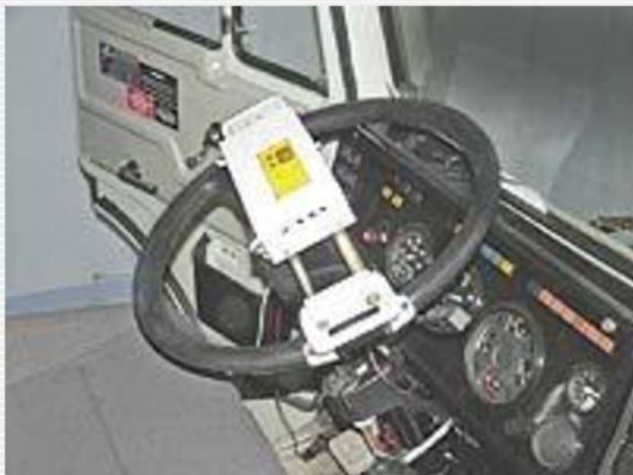
Проверка свободного хода рулевого колеса люфтомером
