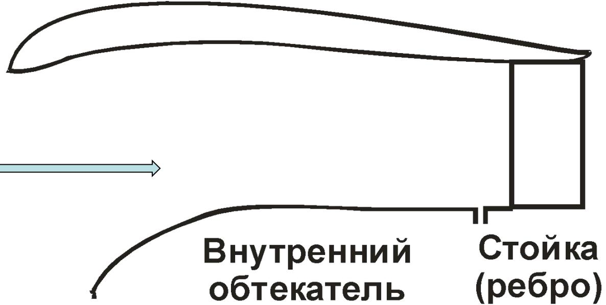
Внешний обтекатель имеет профилированную переднюю кромку.
