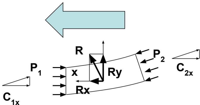
для их определения выделим канал, ограниченный твердыми стенками, и возьмем в нем два сечения 1-1 и 2-2.
