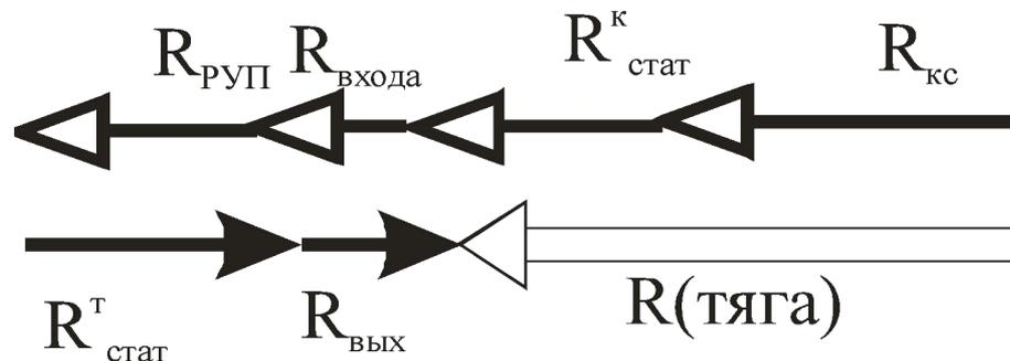
Таким образом, тяга является равнодействующей всех осевых газовых сил, действующих на корпус и направлена в сторону полета.
