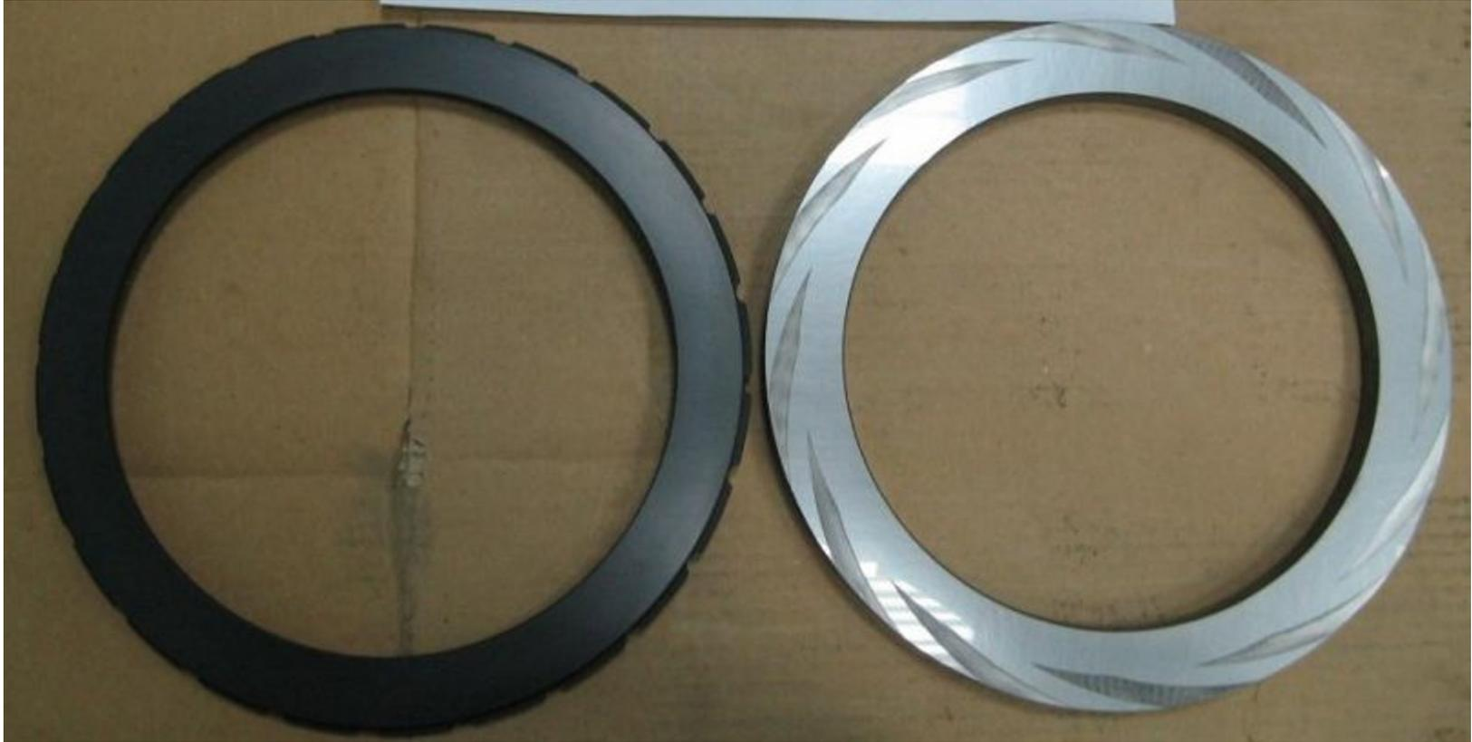
**Лучшим из мягких графитов является электрографит с пропиткой сурьмой; из твердых сплавов - карбид кремния. Возможна комбинация SiC-SiC для напряженных условий работы уплотнения. В этом случае на рабочие поверхности наносится тонкий слой (1...3 мкм) изнашиваемого графитового (алмазного) покрытия, чтобы исключить сухое трение при пуске и останове турбомашин.**
