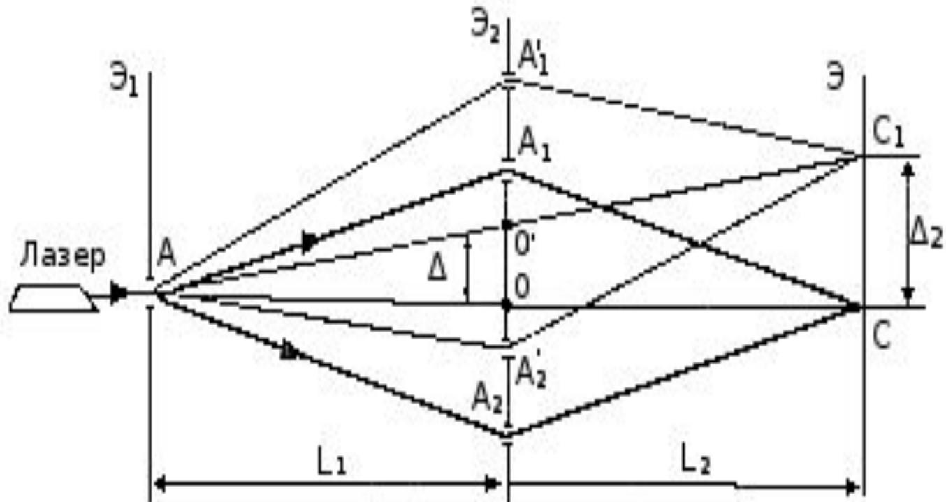
Рис. 1 Схема дифракционного способа створных измерений
