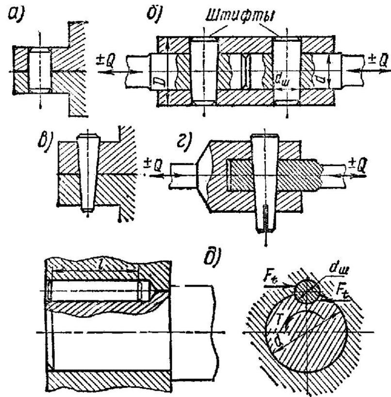
Штифты применяются также для защиты механизмов от перегрузок. В этом случае его размеры выбираются такими, чтобы при определенном усилии он срезался.
