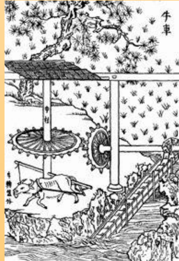
Китайская передвижная ирригационная машина нючэ с бычьим приводом. Рисунок из книги Ван Чжэна “Нун шу” (“Книга о земледелии”), изданной в 1314 г.
