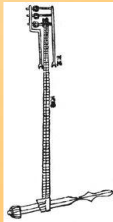
Самая старая известная иллюстрация замкнутой цепной передачи, изданная Су Суном в "Новом проекте астрономических часов" в 1094 г.
