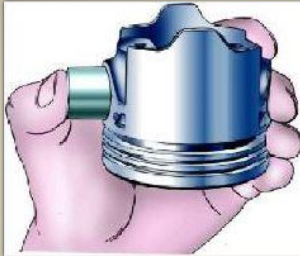
Рис. 26. Поршневой палец должен устанавливаться простым нажатием большого пальца
