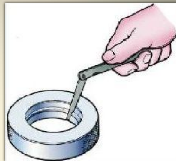
Рис. 29. Проверка зазора в замке колец
