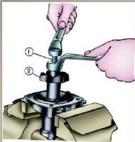
Рис. 63. Снятие крыльчатки насоса: 1 — съемник А.40026; 2 — крыльчатка
