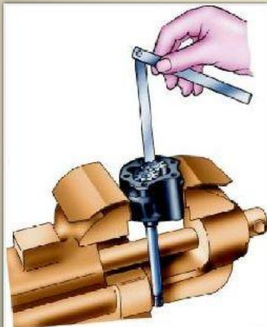
Рис. 71. Проверка радиального зазора в масляном насосе
