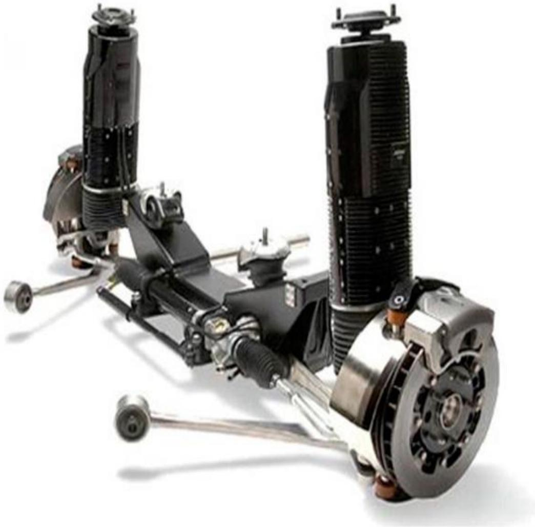
Идея, безусловно, не нова. Но никому еще не удавалось добиться хотя бы схожего быстрогодействия. Шток амортизатора, с закрепленными на нем постоянными магнитами, совершает возвратно-поступательные движения по длине обмотки статора, расположенного в корпусе узла.
