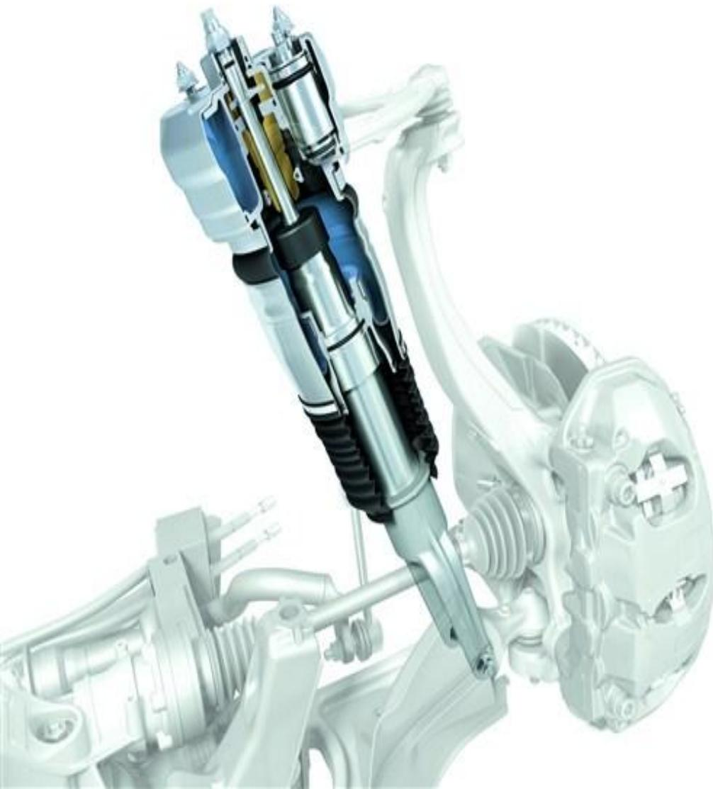
Поступившие сигналы обрабатываются, и формируются сигналы для исполнительных устройств в соответствии с выбранной водителем программой, которых, как правило, три – нормальный, комфортный и спортивный. Для более корректного функционирования адаптивной подвески ее управляющий блок постоянно "сотрудничает" с другими системами авто: рулем, КПП, системой управления двигателем. Этим достигается наиболее четкое функционирование активной подвески.
