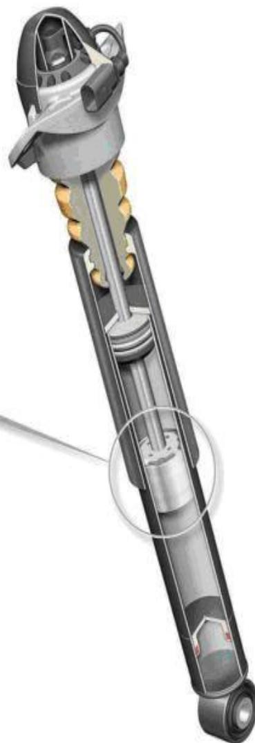
**Магнитореологической жидкостью** принято называть состав, в котором во взвешенном состоянии находятся микроскопические частицы железа, кобальта или никеля. Попросту говоря, частички материалов, способных взаимодействовать с магнитным полем. Результатом такого взаимодействия становится изменение пределов текучести вещества.
