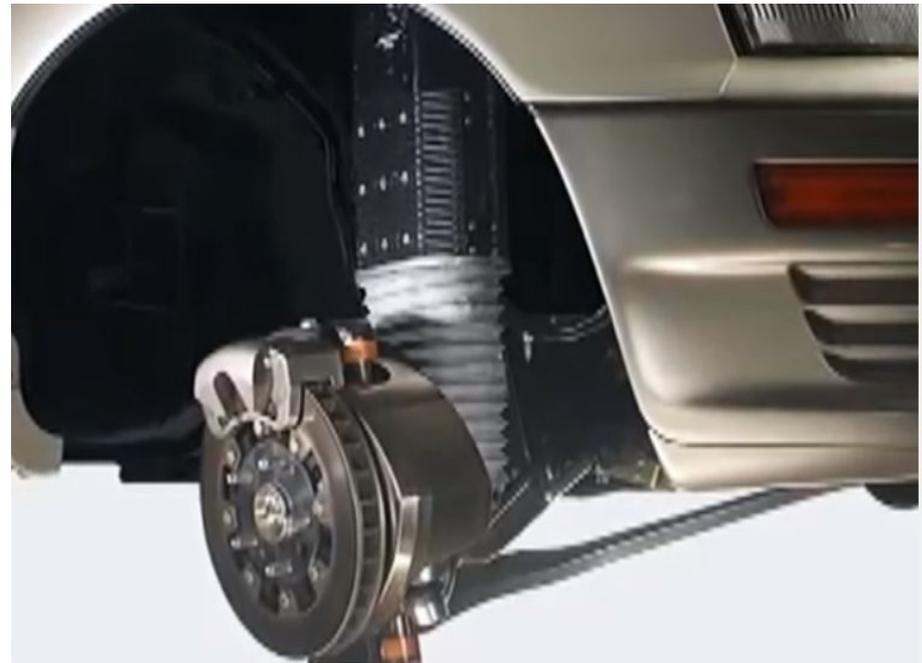
Электромагнитная подвеска автомобиля представляет собой конструкцию, в основе которой лежит электродвигатель. Этот двигатель имеет два режима работы: как демпфирующий элемент и как упругий элемент. Режим работы определяет микроконтроллер. Таким образом, этот электродвигатель заменяет стандартный автомобильный амортизатор
