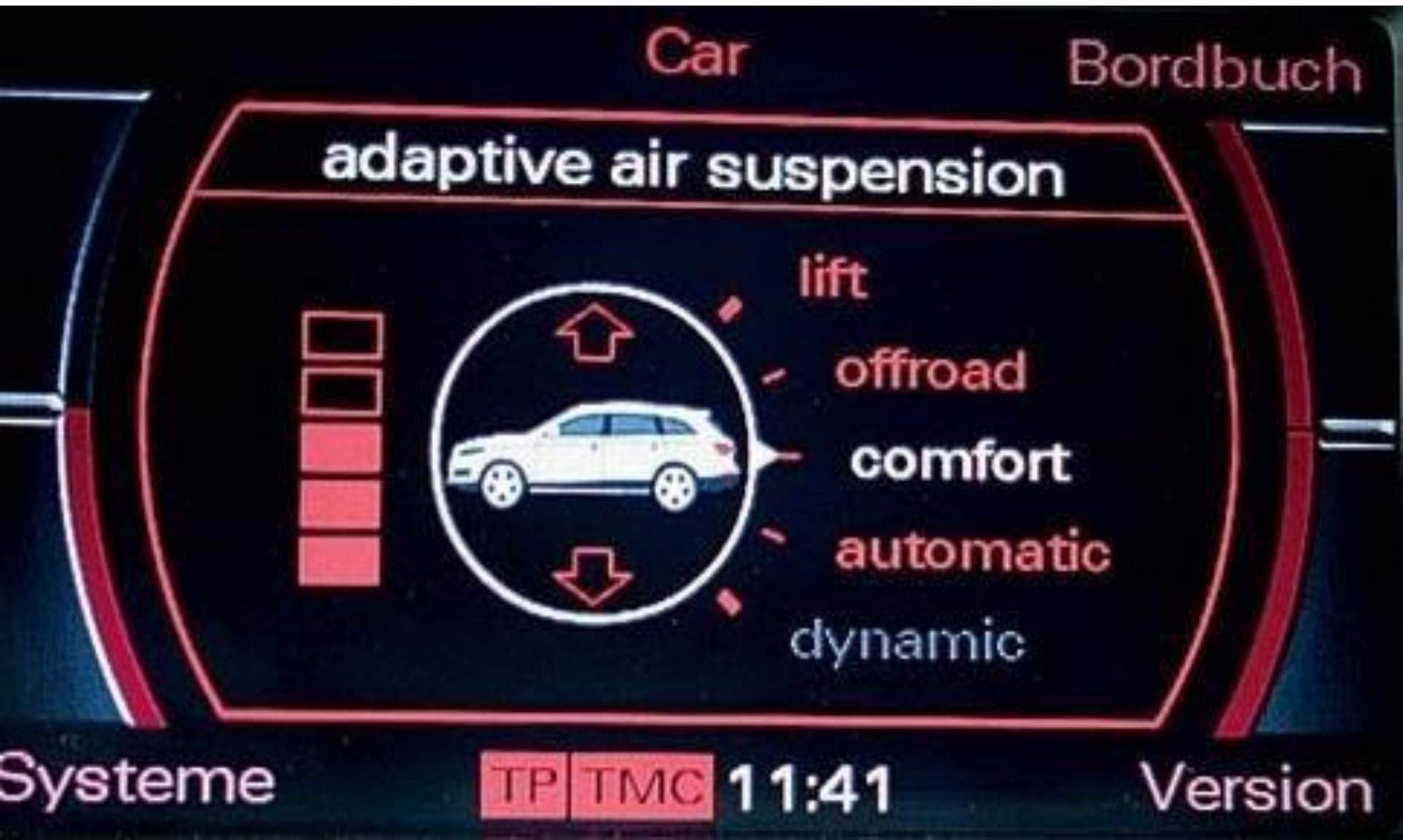
Эта система регулирования дорожного просвета, которая в отличие от своей предшественницы гидропневматической системы, полностью основывается на несущих пневмобаллонах, что позволяет регулировать дорожный просвет вне зависимости от степени загрузки автомобиля. Так же эта система позволяет адаптировать амортизирующее усилие и жесткость работы пневмостойки к любому дорожному покрытию
