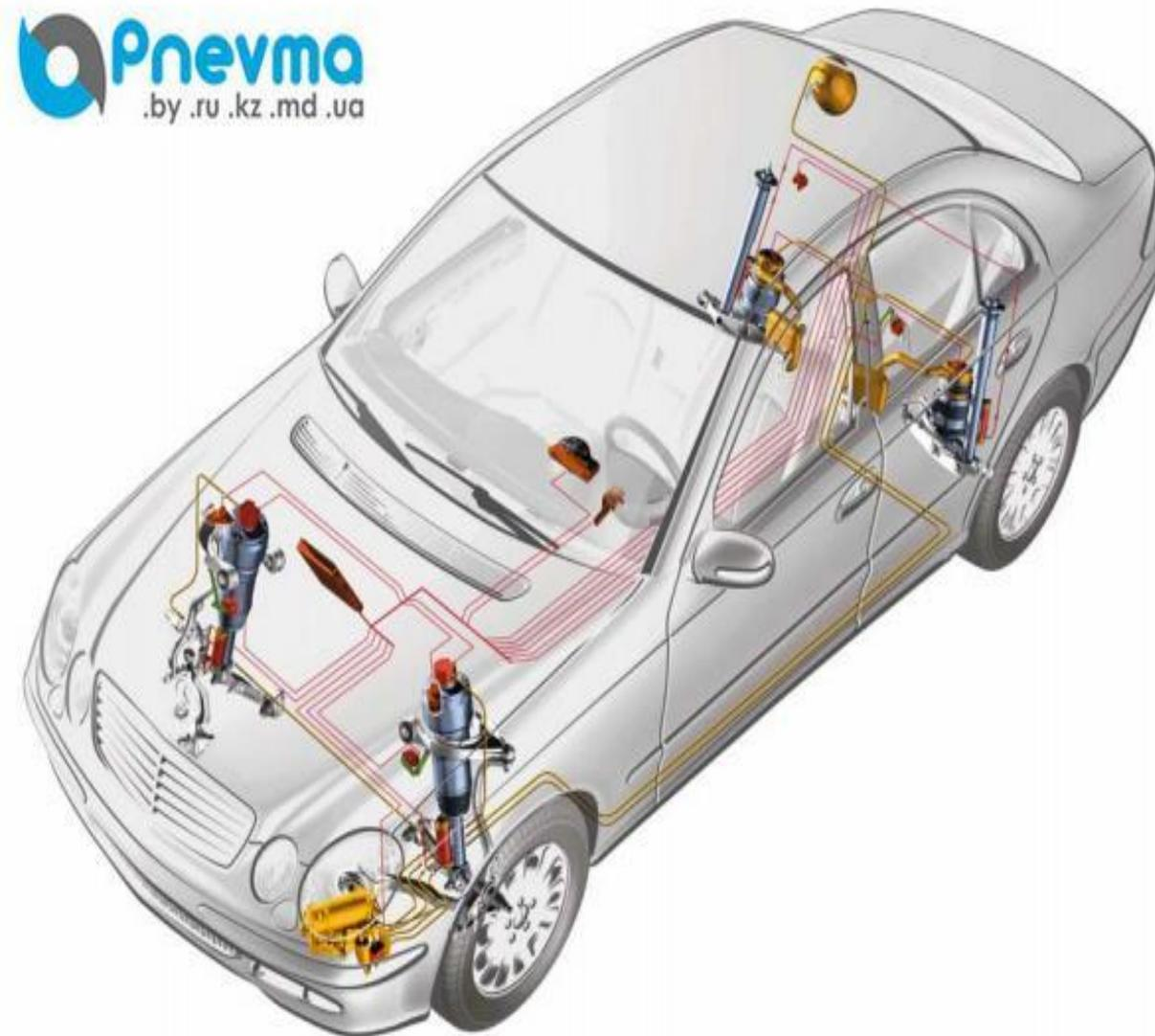
Управление гидроцилиндрами амортизаторных стоек осуществляет электронная система, которая включает 13 различных датчиков (положения кузова, продольного, поперечного и вертикального ускорения, давления), блока управления и исполнительных устройств - электромагнитных клапанов.
