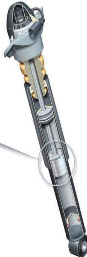
Магнито-реологическая жидкость включает металлические частицы, которые при воздействии магнитного поля выстраиваются вдоль его линий. В амортизаторе, заполненном магнито-реологической жидкостью, отсутствуют традиционные клапаны
