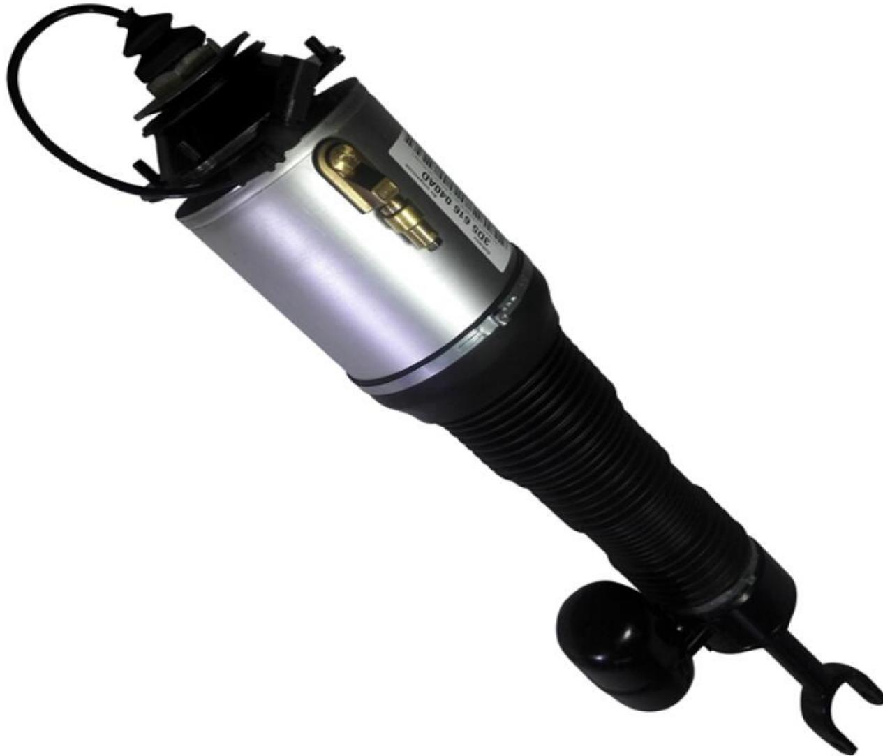
Бортовой компьютер фиксирует показания всех датчиков. На основе собранных данных изменяется жесткость демпферного элемента. В результате выбирается оптимальный режим езды
