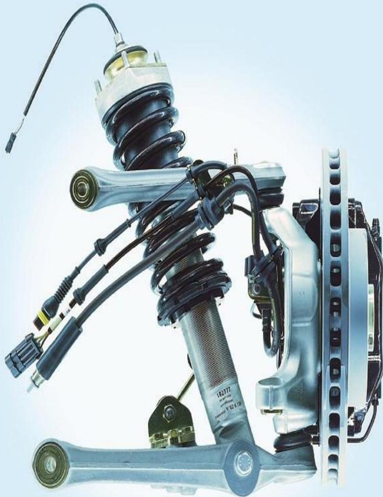
Электрогенератор – еще один режим работы подвески Боуза. При передвижении машины по прямой, колебания, вызванные неровностью дорожного покрытия, преобразовываются в электрический ток. Энергия не рассеивается в пространстве, а собирается в аккумуляторных батареях для дальнейшего использования ([рекуперации](#)).
