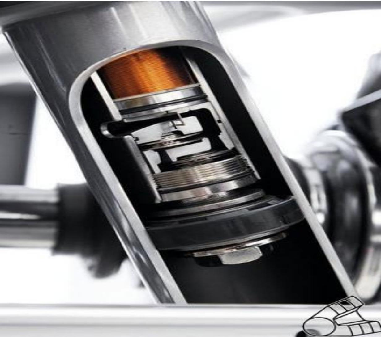
В современных конструкциях адаптивной подвески используется два способа регулирования степени демпфирования амортизаторов
