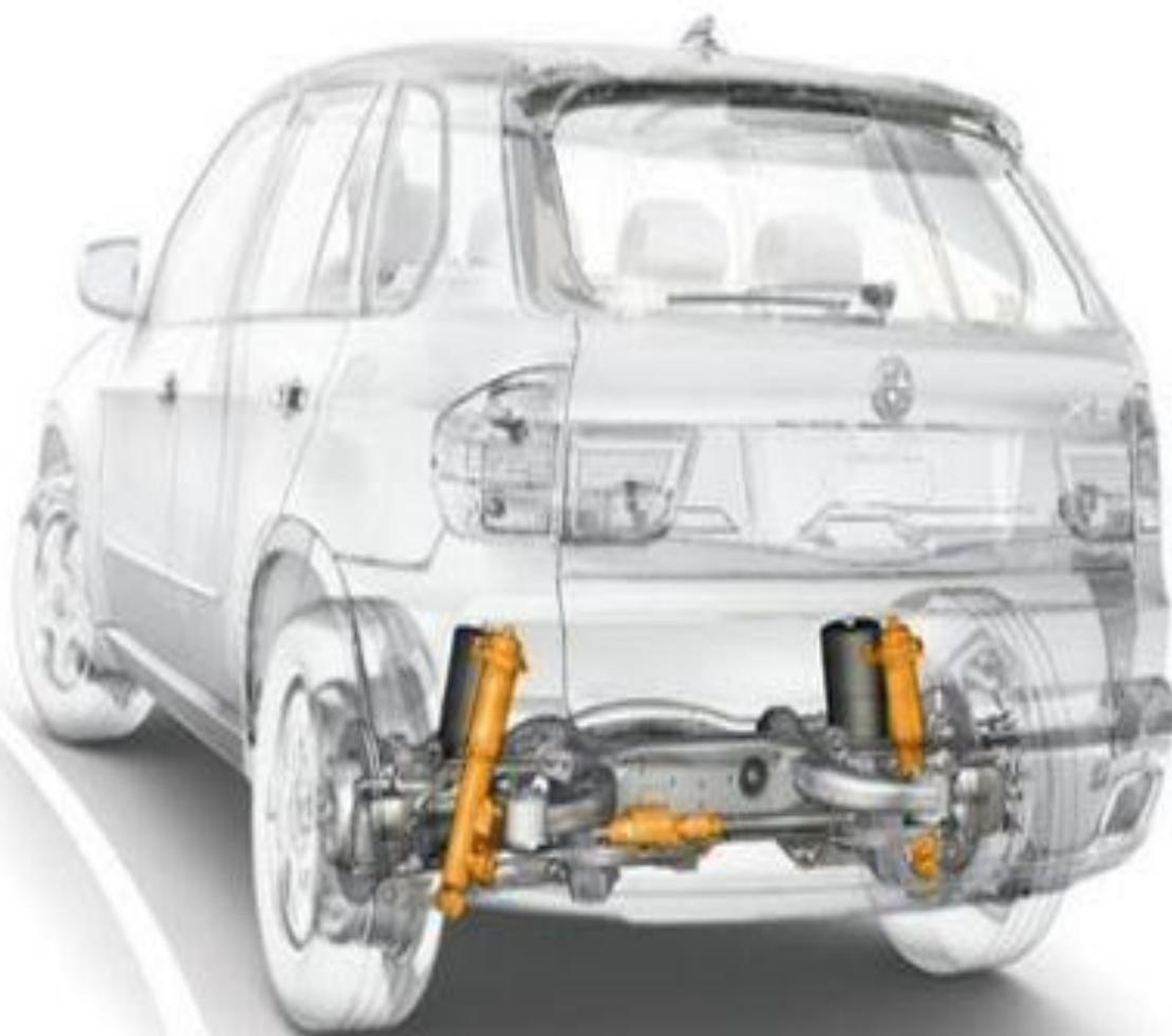
Вариант адаптивной подвески от BMW, названный Dynamic Drive, в купе с электронной системой регулировки жесткости амортизаторов (по принципу тех же электромагнитных клапанов), обеспечивают превосходные показатели комфорта при езде на BMW
