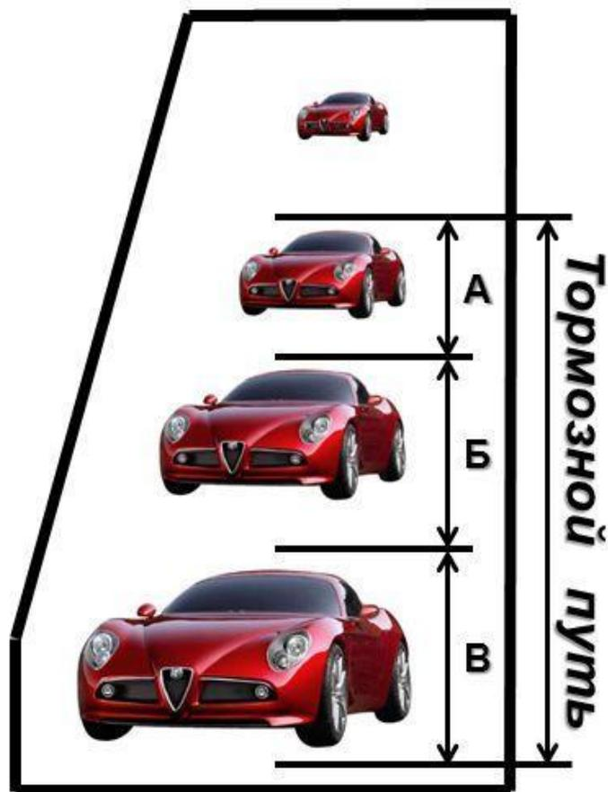
**Тормозной путь машины складывается из нескольких составляющих: время когда водитель видит опасность и нажимает на тормоз (зона А), время срабатывания тормозов (зона Б), когда автомобиль тормозит на дороге (зона В).**
