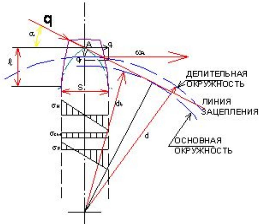
$$q'_t = q * \text{Cos} \alpha' = \omega_{Ft} \frac{\text{Cos} \alpha'}{\text{Cos} \alpha} \quad \text{Сила, изгибающая зуб,}$$
