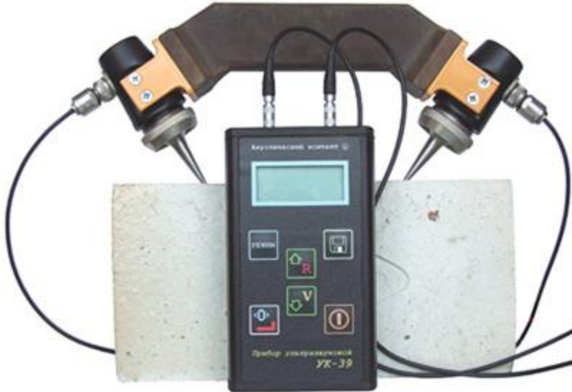
Ультразвуковий метод вимірювання міцності бетону
