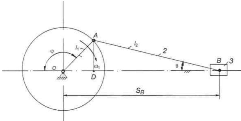
Пусть в качестве исходных данных известны: длины кривошипа  $l_1$  и шатуна  $l_2$ , положение ведущего звена  $\varphi$ , частота вращения  $\omega_1$ . Требуется определить функцию положения ползуна 3 – зависимость координаты точки  $B$  ползуна  $S_B$  от угла поворота  $\varphi$ .
