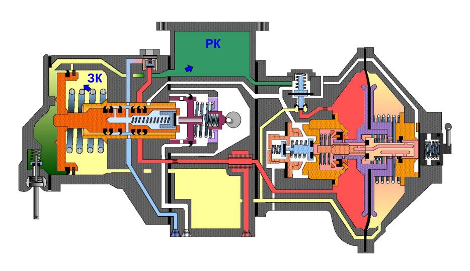
Из двухкамерного резервуара по каналу сжатый воздух поступает в магистральную часть в полость П, но малая диафрагма не прогибается — на неё действует усилие пружин переключателя режимов переключенного на горный режим.
