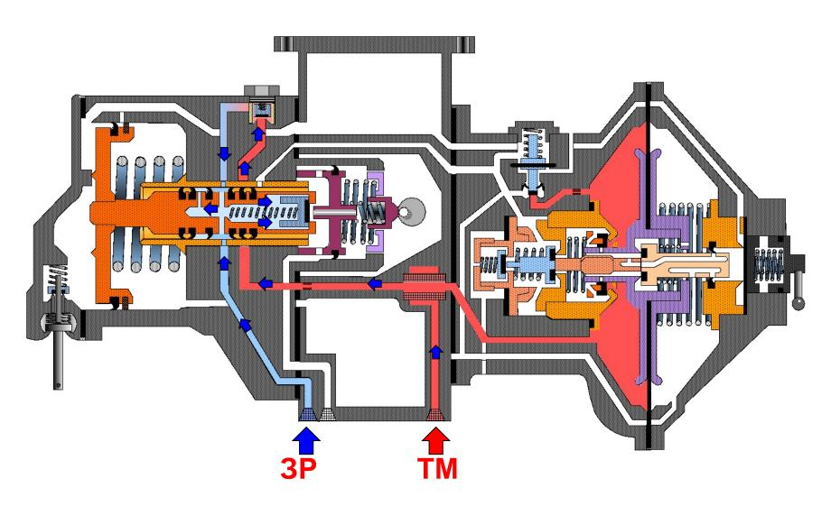
При повышении давления в магистральной камере на 0,3 диафрагменный узел смещается вправо и открывается путь воздуху для зарядки золотниковой камеры.
