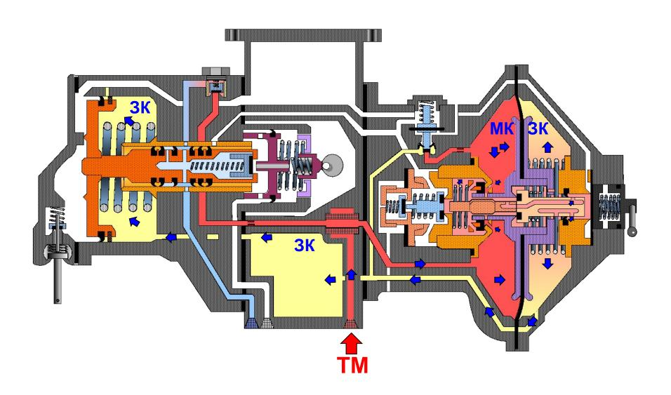
Из золотниковой камеры в главной части происходит зарядка рабочей камеры на равнинном режиме через отверстие Ø 0,5 мм в цилиндре главной части. Зарядка рабочей камеры с 0 до 5,0 происходит за 3 – 3,5 мин.
