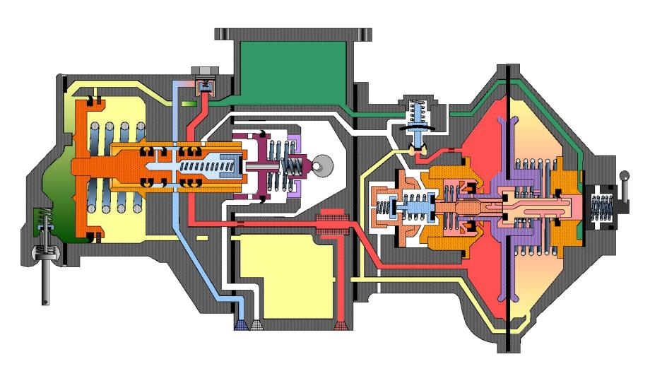
Камера дополнительной разрядки и полость Д над клапаном мягкости при зарядке сообщается с атмосферой каналом через главную часть.
