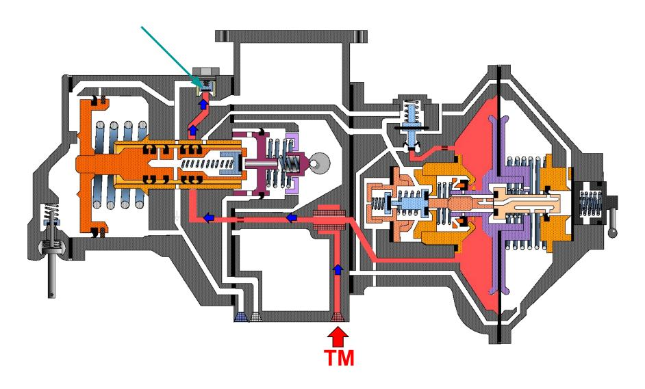
Сжатый воздух по каналу непосредственно из ТМ поступает в запасный резервуар (3P), время зарядки которого составляет 4,0 – 4,5 мин.
