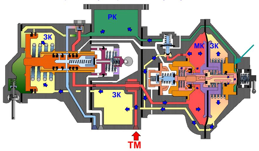
При выравнивании давлений в рабочей, золотниковой и магистральной камерах диафрагма, под давлением пружины, смещается в среднее положение, разобщая МК и ЗК через отверстие в плунжере.
