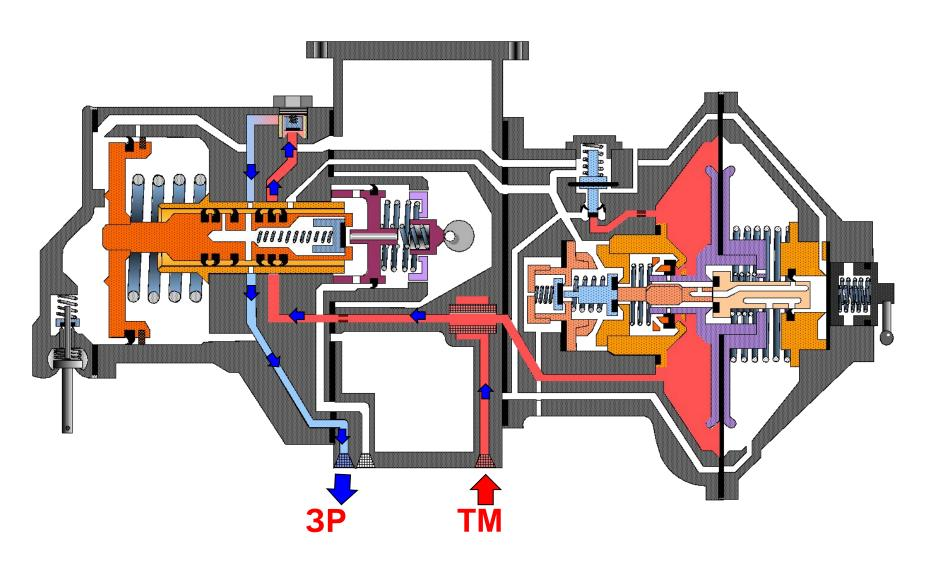
Из запасного резервуара сжатый воздух по каналу, и через отверстия во втулке главного поршня поступает в полость между Зей и 4ой манжетами штока главного поршня.
