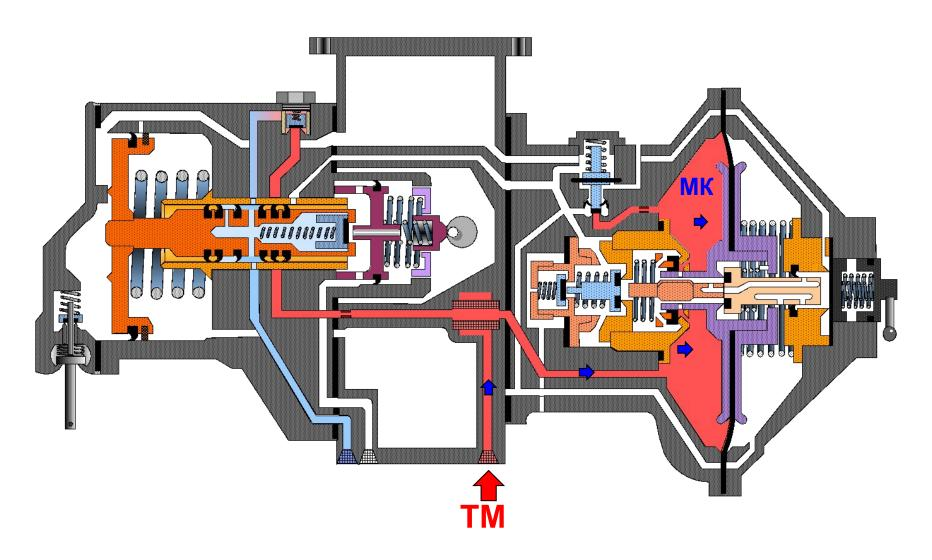
Воздух из магистральной камеры поступает через 6 отверстий Ø 2 мм во втулке срывной камеры, далее через два отверстия Ø 1 мм в хвостовике левого диска диафрагмы в срывную камеру.
