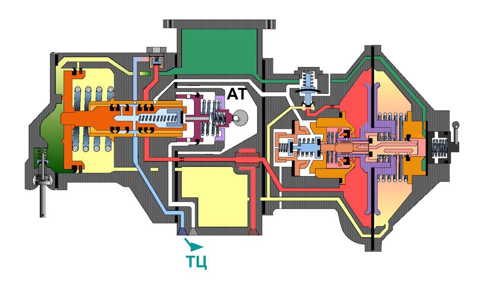
При снижении давления в ТМ темпом мягкости от 0,2 – 0,5 кгс/см2, сжатый воздух из ЗК начинает перетекать в МК через клапан мягкости не перемещая диафрагменного узла.
