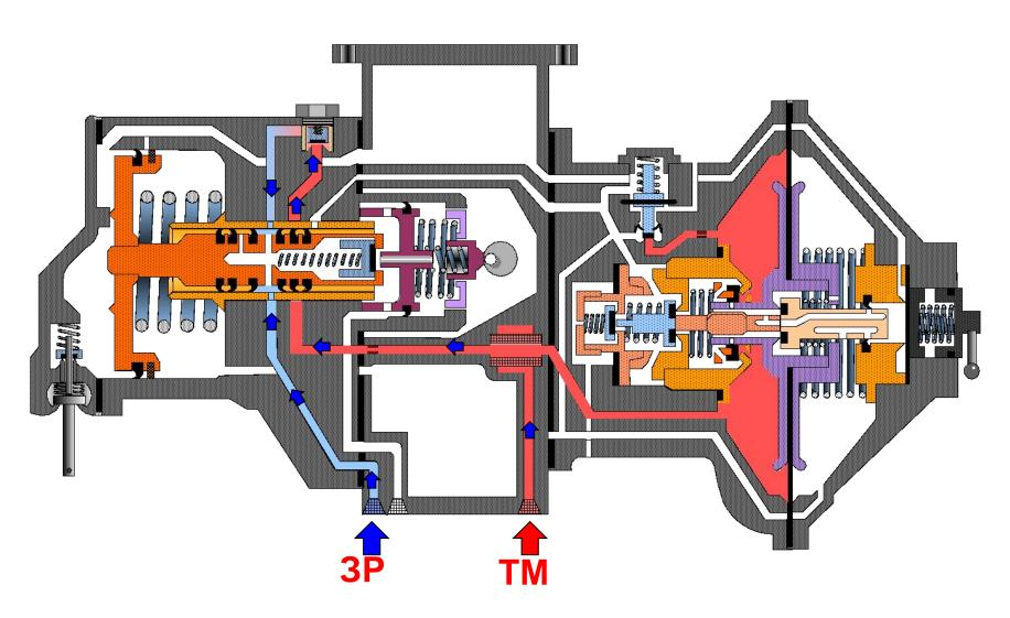
Далее через 4 отверстий Ø 3,0 мм в штоке главного поршня поступает в полость внутри штока к тормозному клапану, который своей пружиной прижат к седлу.
