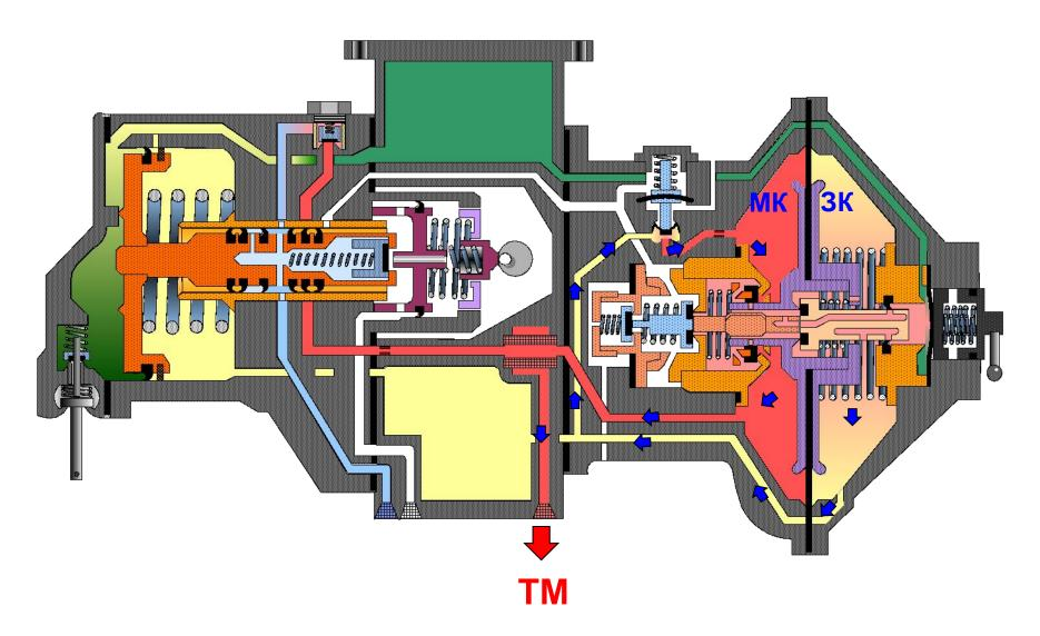
При большем снижении давления в МК темпом мягкости, диафрагма смещается влево, открывается клапан дополнительной разрядки, и начинается разрядка ЗК через верхний канал плунжера, через канал толкателя в КДР. Из неё воздух поступает по каналу в главную часть, где происходит «пшик» в атмосферу через ниппель уравнительного поршня.
