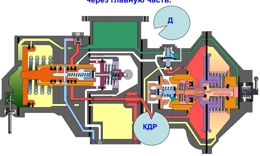
Далее через 8 отверстий Ø 1,6 мм во втулке главного поршня в тормозную камеру, и через ниппель уравнительного поршня Ø 2,8 мм в атмосферу.
