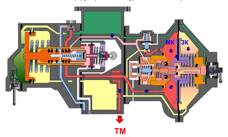
Если дальнейшего снижения давления в ТМ не происходит, то под давлением МК диафрагменный узел смещается вправо, разобщая ЗК с атмосферой. Клапан дополнительной разрядки, освободившись от действия толкателя, под действием пружины закрывается, а воздух из КДР уходит в атмосферу через главную часть.
