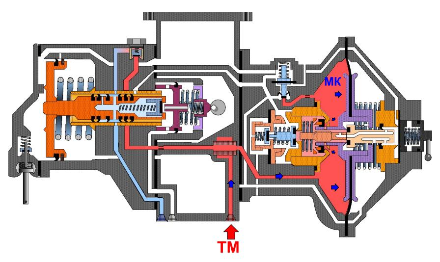
Из срывной камеры воздух поступает через ниппель плунжера Ø 2 мм по каналу плунжера и верхнее отверстие Ø 0,7 мм в хвостовике плунжера...
