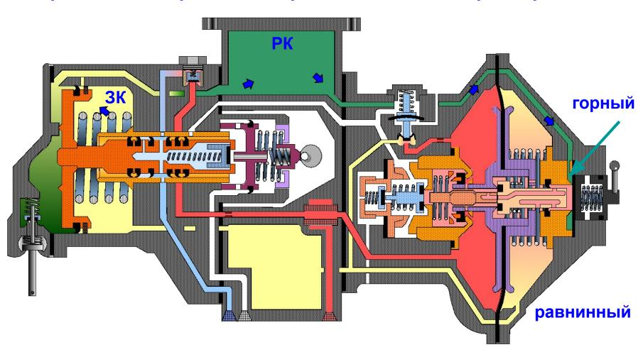
При выравнивании давлений в МК, ЗК и РК диафрагма под усилием пружины перемещается в среднее положение, разобщая МК и ЗК через каналы плунжера.
