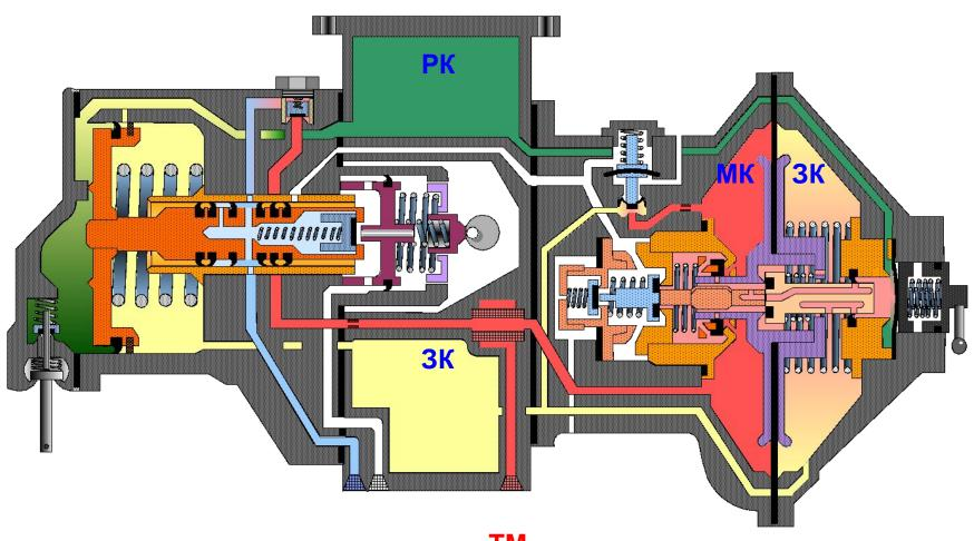
Полный ход диафрагмы составляет 11мм, после ликвидации сверхзарядного давления краном машиниста, расстояние от торца левого диска до седла срывной камеры составляет 4,5 мм.
