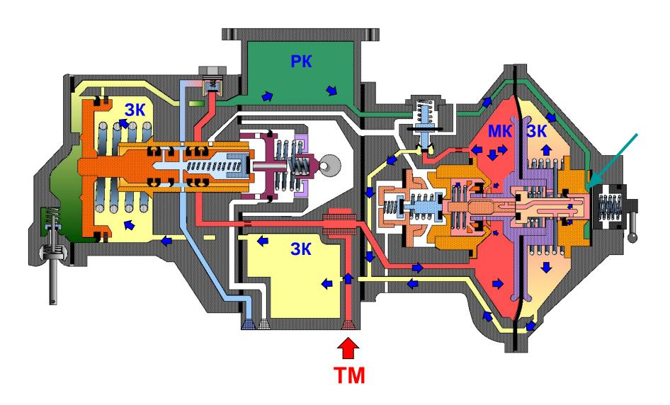
При повышении давления в РК до 3.0 кгс/см2, а в ЗК до 4,5 кгс/см2, суммой давлений на малую диафрагму она прогибается вправо и начинается 2ой путь зарядки РК из полости П через отверстие Ø 0,6 мм. При повышении давления
