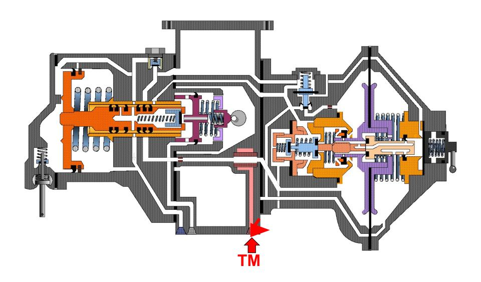
Поступает в главную часть к обратному клапану через отверстие Ø 1,3 мм и в магистральную часть в магистральную камеру (МК).
