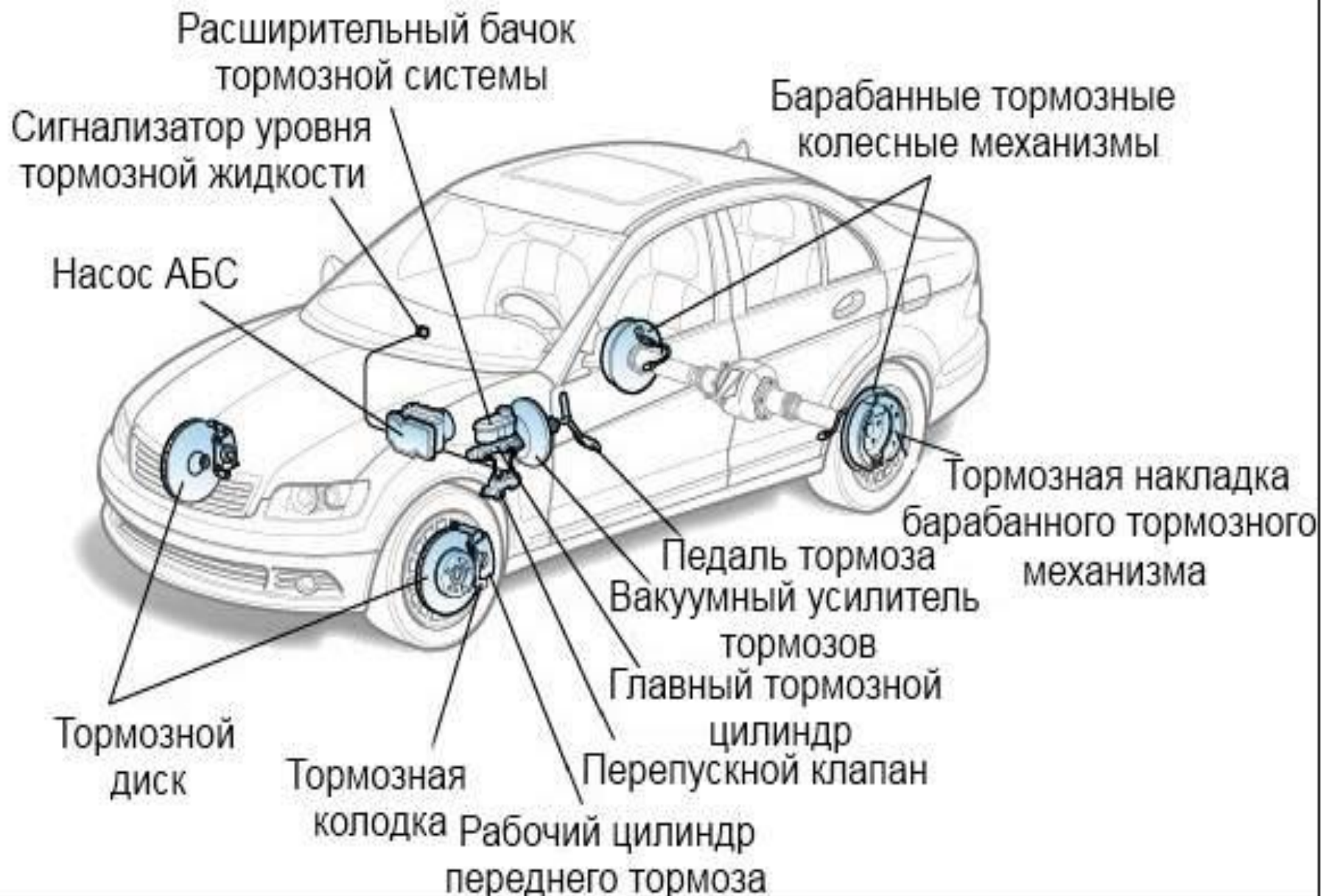
Устройство современной тормозной системы автомобиля
