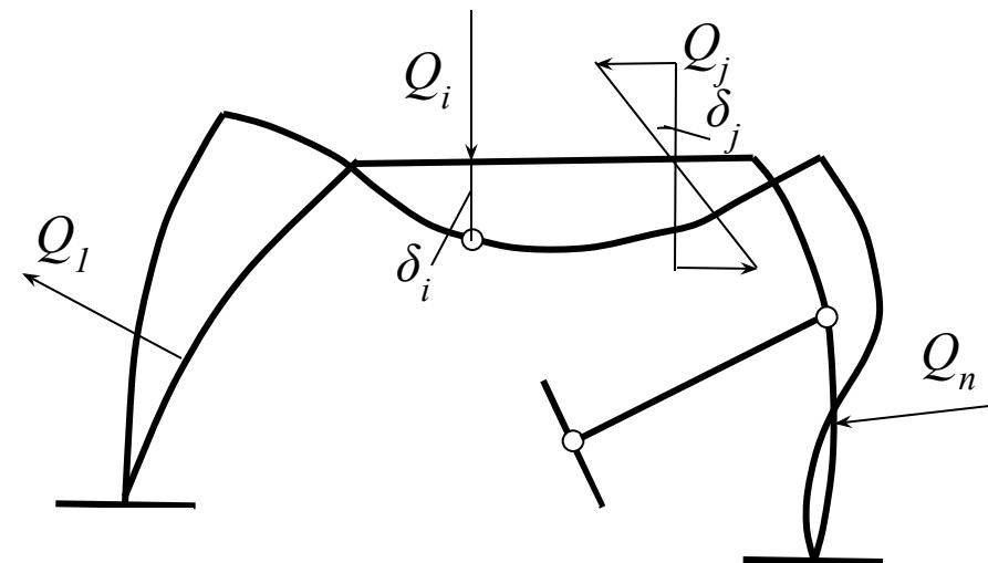
Из закона Гука в силах и перемещениях для  $n$  обобщенных сил, действующих на механическую систему, получим систему  $n$  линейных уравнений, в которых  $\delta_i$  выражены через  $Q_i$ :
