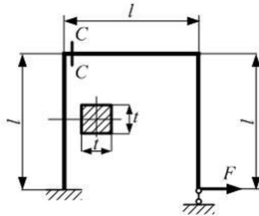
На рисунке показана рама с постоянным по контуру квадратным поперечным сечением, нагруженная силой  $F$ . Модуль упругости материала  $E$ . Определить максимальное нормальное напряжение в сечении С-С рамы, вызванное изгибающим моментом.
