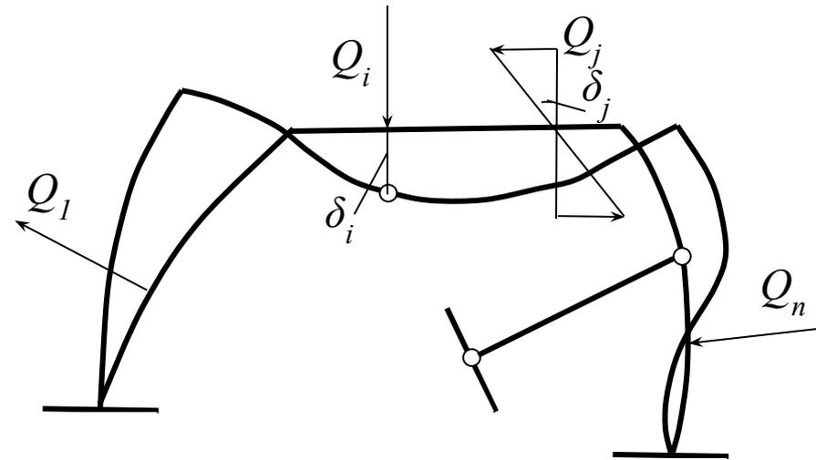
Из закона Гука в силах и перемещениях для  $n$  обобщенных сил, действующих на механическую систему, получим систему  $n$  линейных уравнений, в которых  $\delta_j$  выражены через  $Q_i$ :
