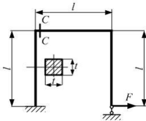
На рисунке показана рама с постоянным по контуру квадратным поперечным сечением, нагруженная силой  $F$ . Модуль упругости материала  $E$ . Определить максимальное нормальное напряжение в сечении  $C-C$  рамы, вызванное изгибающим моментом.
