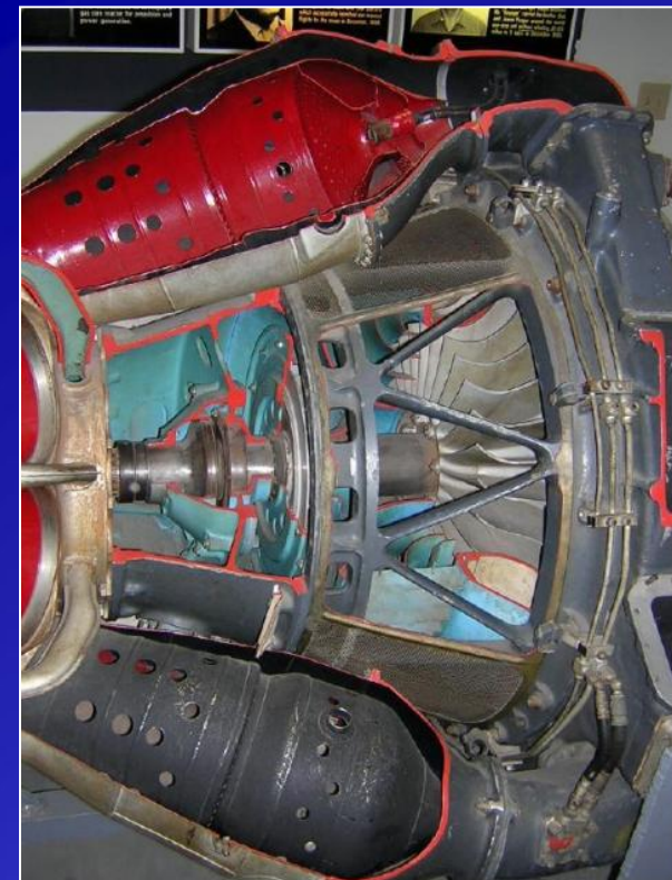
Трубчатые КС ГТД Rolls-Royce RB.41 Nene
