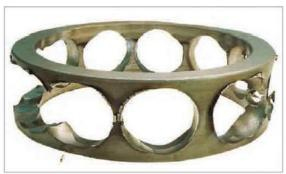
Под действием переменных напряжений в материалах происходит процесс постепенного накопления повреждений, приводящий к образованию трещин, их развитию и разрушению.
