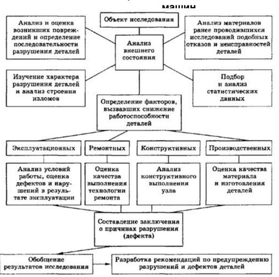
схема проведения исследований по выявлению причин отказов элементов машин
