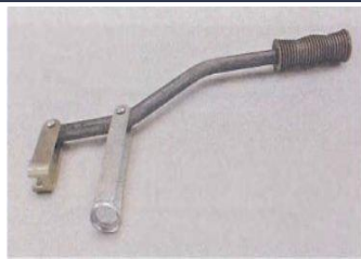
Устройство для зажимания пружинки клапана
