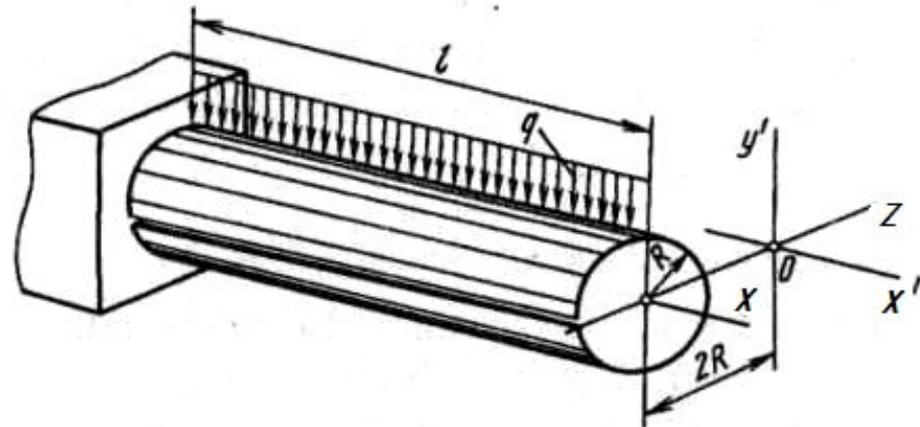
Дополнительные касательные напряжения кручения распределяются в сечении по законам для открытого профиля. При этом
