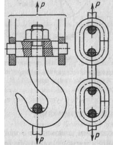
Введем необходимые обозначения. Через  $\rho_0$  обозначим радиус кривизны оси бруса (линии центров тяжести сечений), а через  $r_0$  - радиус кривизны нейтрального слоя.
