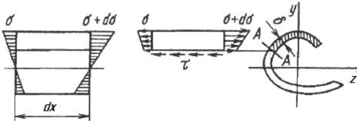
Касательные напряжения в поперечных сечениях тонкостенного стержня определяются по тому же принципу, что и для сплошного стержня. Разность нормальных сил для элементарного участка, расположенного по одну сторону от продольного разреза, уравнивается касательными напряжениями  $\tau$ .
