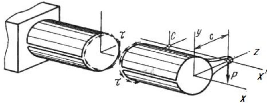
Тот же самый стержень, заземленный одним концом и находящийся под действием собственного веса, будет закручиваться. Крутящий момент в заделке равен:
