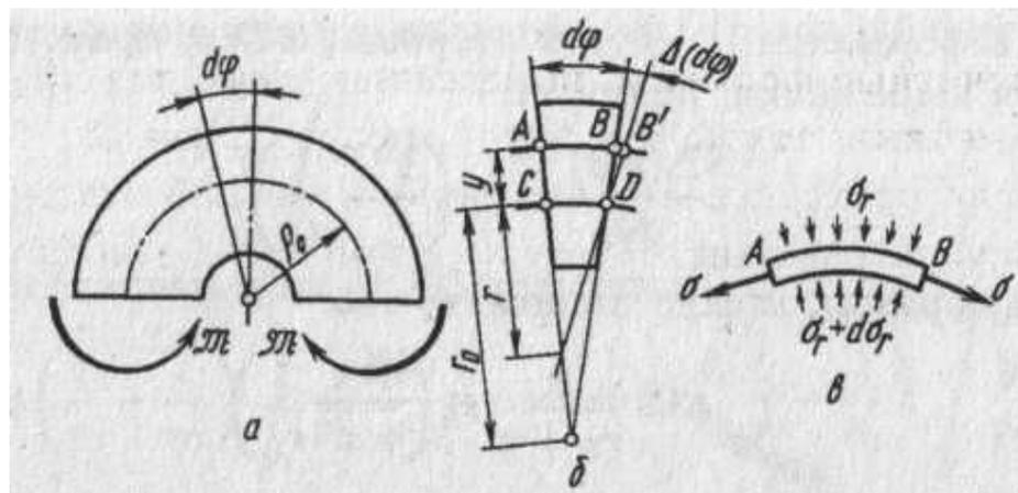
Так же как и для прямого бруса, можно показать, что множество точек, образующих до изгиба поперечное сечение бруса, после изгиба также образует плоское сечение, но повернутое в пространстве. Иными словами, поперечные сечения бруса большой кривизны при чистом изгибе остаются плоскими.
