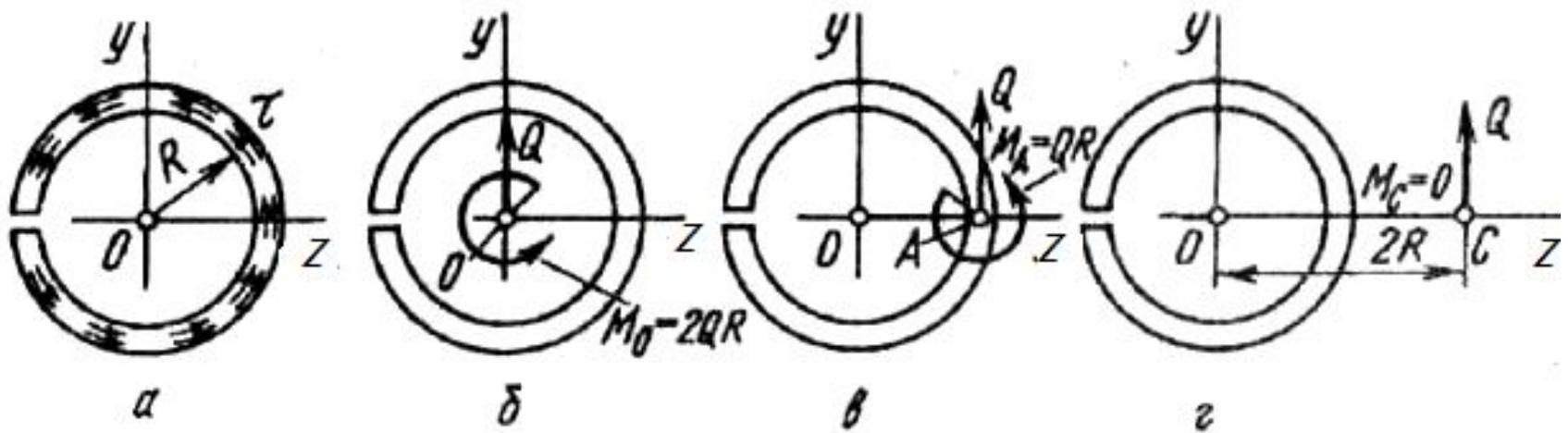
Что касается равнодействующего момента в сечении, то он зависит от положения точки приведения сил. Так, например, в том же случае кругового незамкнутого профиля момент касательных сил относительно центра круга будет:
