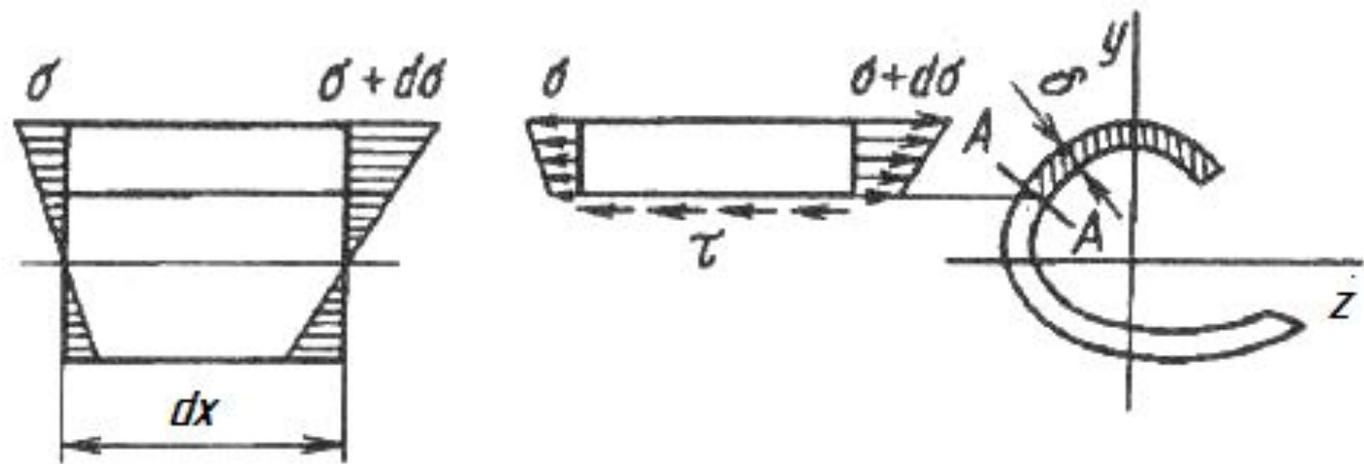
В отличие от стержня сплошного сечения продольный разрез тонкостенного стержня следует производить не параллельной нейтральному слою плоскостью, а плоскостью А-А, нормальной к средней линии контура. Такое сечение имеет наименьшую ширину, равную  $\delta$ , и в нем касательные напряжения, уравнивающие разность нормальных сил, будут больше, чем в других продольных сечениях.
