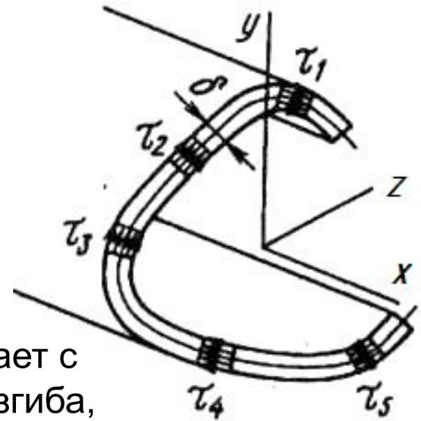
Если направление поперечной силы  $Q$  не совпадает с главной осью сечения, то, как и в случае косоугольного изгиба, эта сила может быть разложена на составляющие  $Q_y$  и  $Q_z$ , направленные по главным осям.
