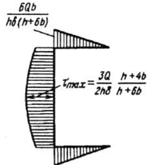
На рис. показана эпюра распределения касательных напряжений по контуру. Знак  $\tau$  вдоль контура, как видим, не меняется. Следовательно, найденное касательное напряжение сохраняет для всех точек сечения постоянное направление, т.е. либо от края 1 к краю 2, либо же от края 2 к краю 1, в зависимости от знака поперечной силы.
