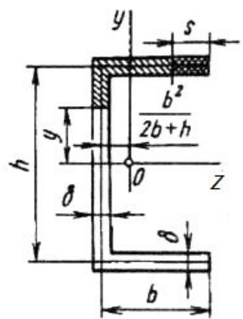
Если разрез сечения произвести на участке вертикальной стенки, статический момент части сечения, расположенной выше уровня  $y$ , будет равен:
