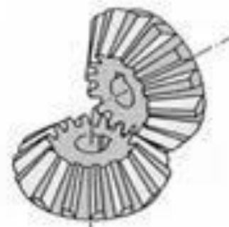
Прямозубая коническая передача
