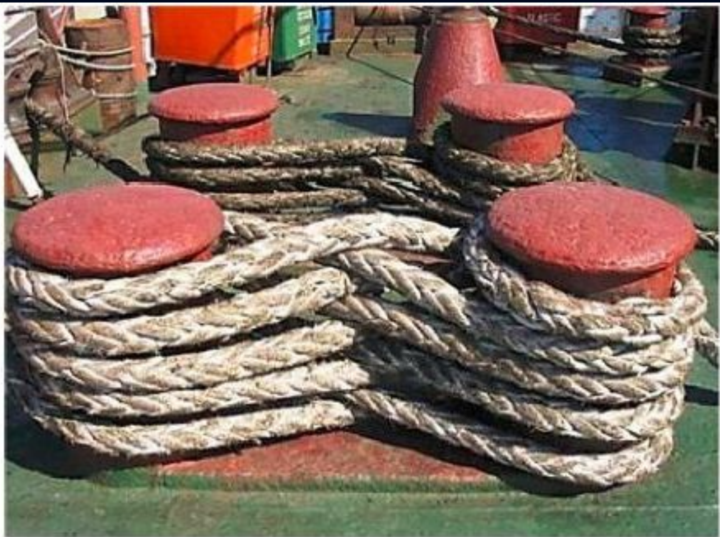
Рис. 6.37. Крепление швартовного троса на кнехте
