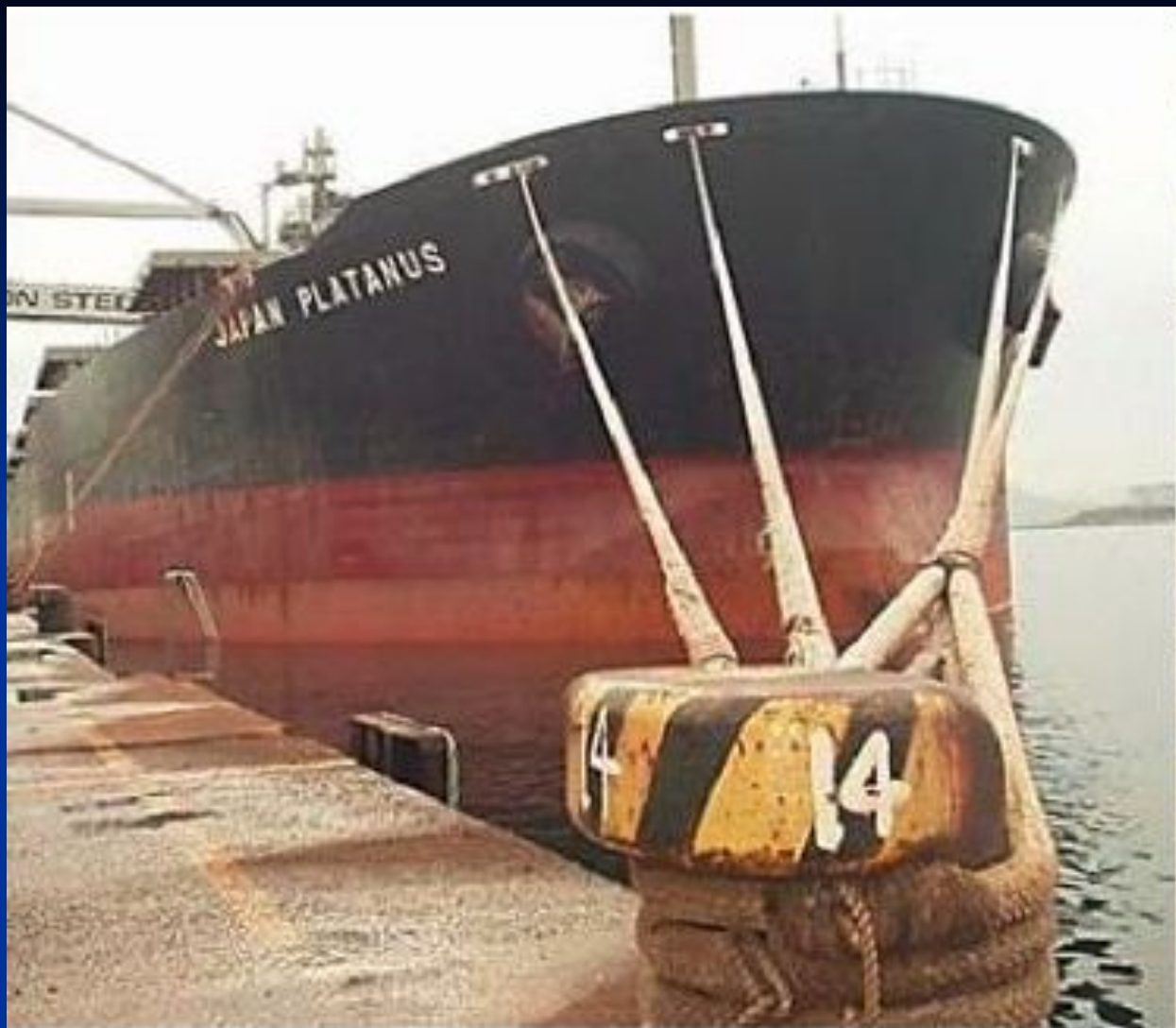
Рис. 6.35. Крепление швартовых на береговой тумбе
