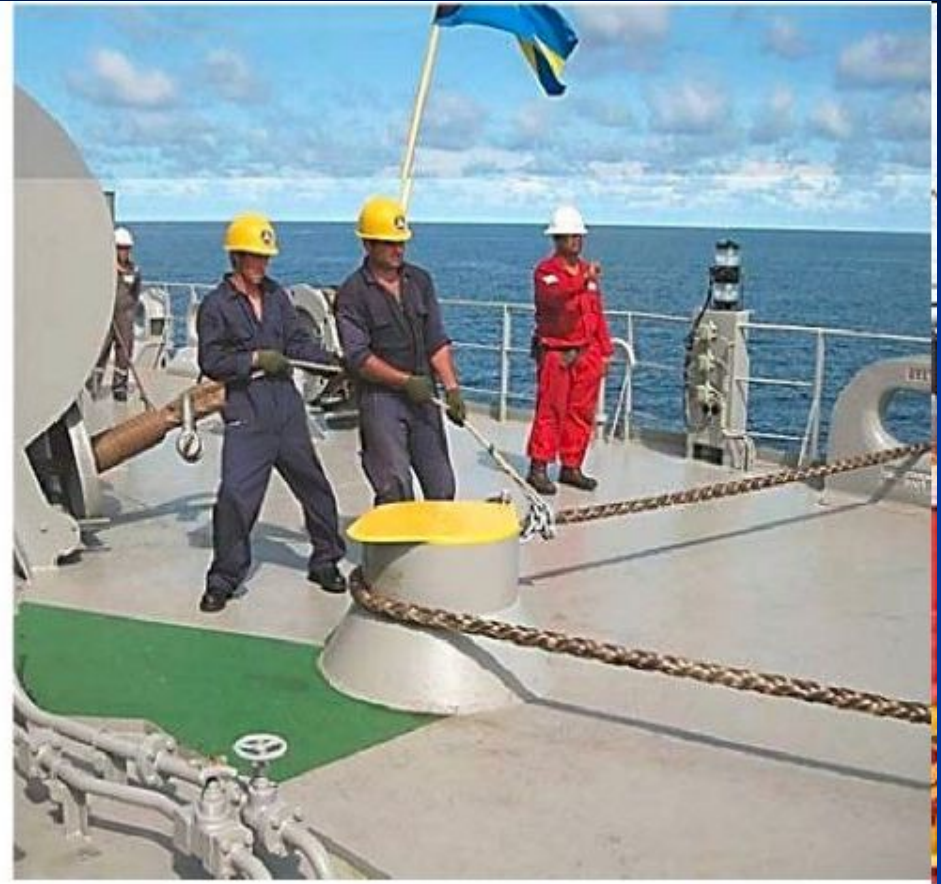
Рис. 6.46. Удержание швартовного троса стопором
