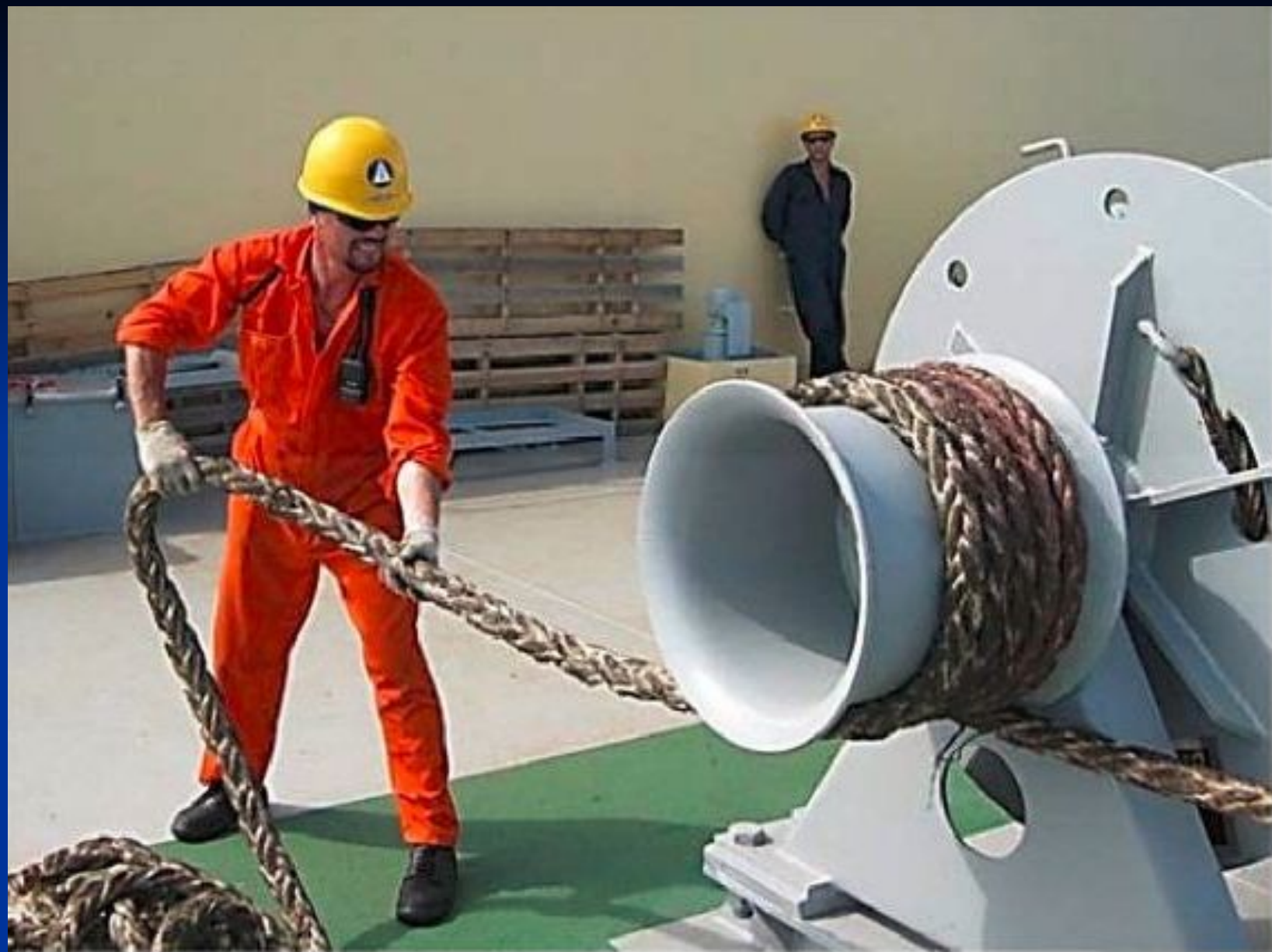
Рис. 6.48. Использование турачки брашпиля
