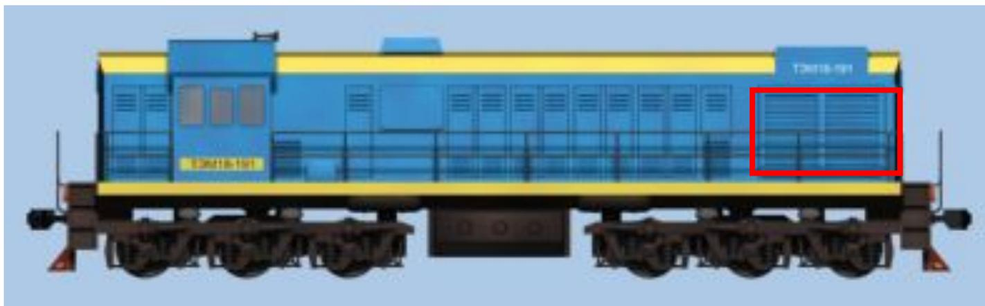
Открытие жалюзей холодильника и запуск вентилятора осуществляется автоматически по фактической температуре воды и масла в контурах охлаждения дизеля.
