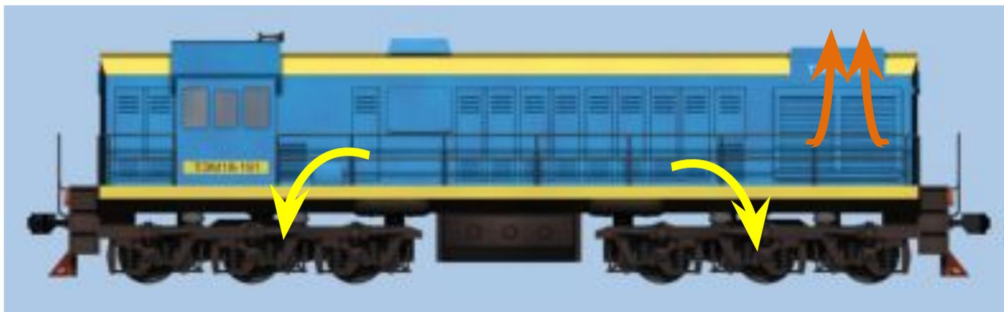
1. От главного вала дизеля тепловоза приводится в действие вентилятор охлаждения холодильника. От вала через клиноременную передачу вентиляторы охлаждения тяговых двигателей (2 шт. для передней и задней тележки)
