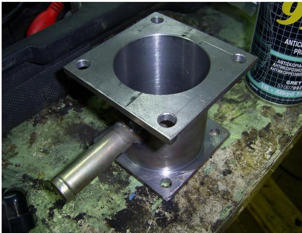
Трубка, приваренная сбоку применяется для переделки с ДАД (датчиком абсолютного давления). Если не планируется в дальнейшем устанавливать ДАД, можно не вваривать. Для ДАДа нужен будет Онлайник обязательно!!!
