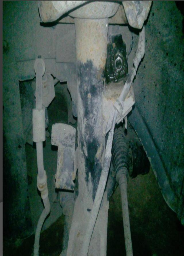
◎ 4) Разводим колодки, трищеткой и головкой на 17 откручиваем тормозной суппорт
