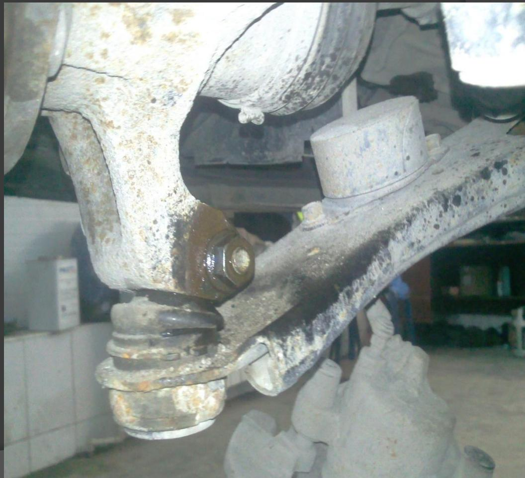
⑦ С помощью большого воротка и головки на 17, отпускаем гайку рулевого наконечника и снимаем его. Для снятия используем специальный съемник, но так как у меня он сломался, я использовал молоток ударяя им по сошке в область посадки шарового пальца
