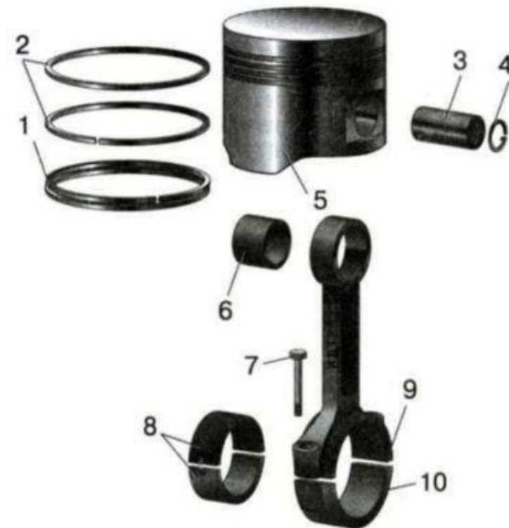
Устройство поршня: 1 - маслосъемное кольцо; 2 - компрессионные кольца; 3 - поршневой палец; 4 - стопорное
