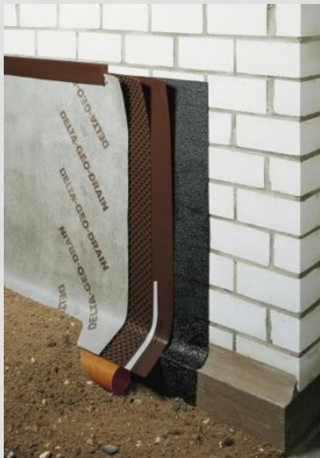
**Дренажные мембраны** изготовлены из особо прочного полиэтилена повышенной плотности, по всей площади мембраны расположены выступы определенной высоты в форме усеченного конуса (высота от 7 до 20 мм)
