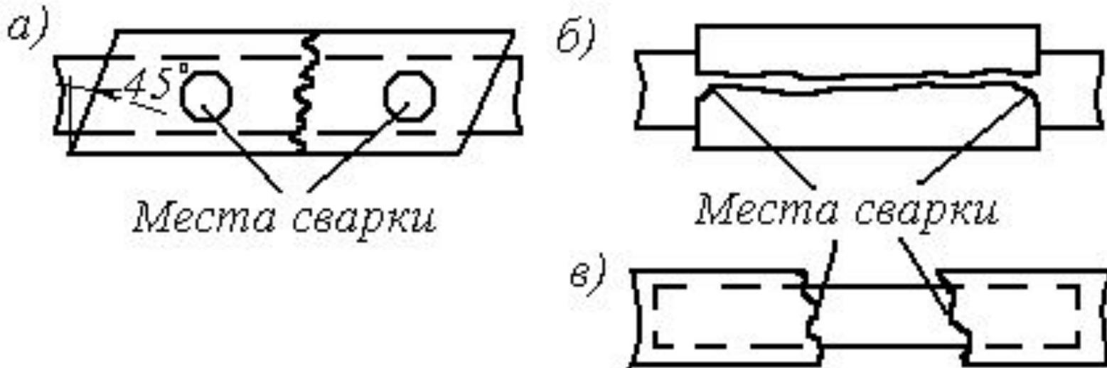
Рисунок 3 – Ремонт трубчатых деталей основания постановкой ДРД.
