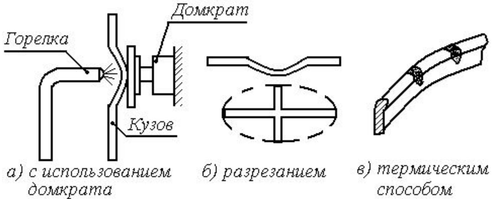
Рисунок 4 – Ремонт кузовов автомобилей-самосвалов.
