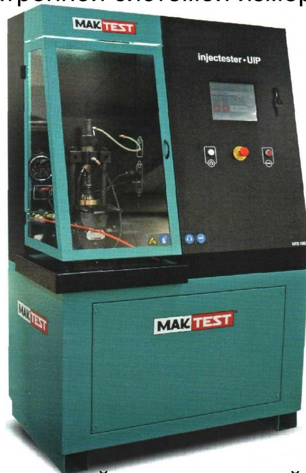
**UTS 1003** Автоматический компьютерный комплекс для тестирования и ремонта **насос-форсунок** с электронной системой измерения
