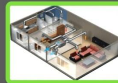
Вентиляция с рекуперацией тепла
