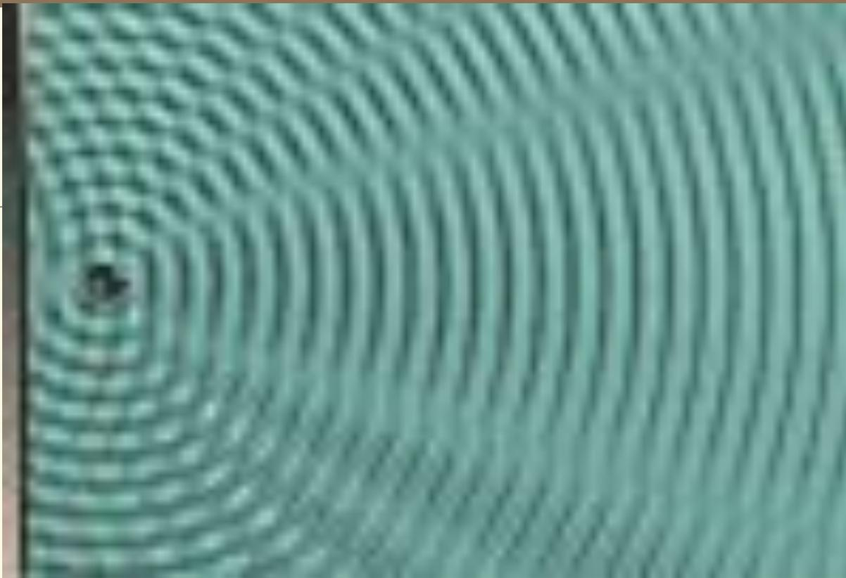
*Расстояние от источника до стенки  $r$  кратно целому числу полуволн, исходная круговая волна интерферирует с волной, отражённой от стенки, поэтому справа от источника на оси соединяющей фиктивный и реальный источник разность хода будет кратна целому числу волн, и круговая волна накладывается в фазе с волной, отражённой от стенки, увеличивая высоту гребней в интерференционной картине*
