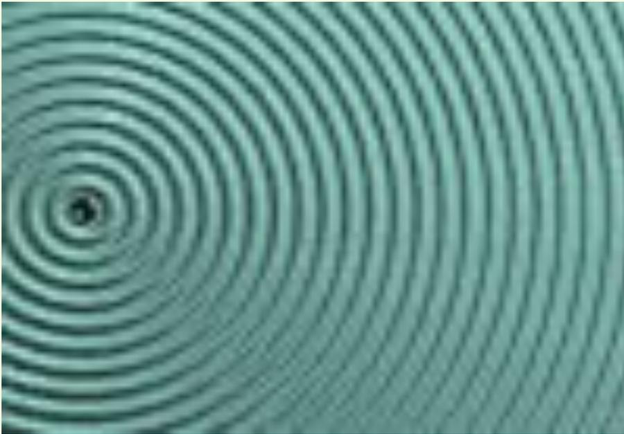
*Круговая волна на поверхности жидкости, возбуждаемая точечным источником (гармонически колеблющимся шариком).*
