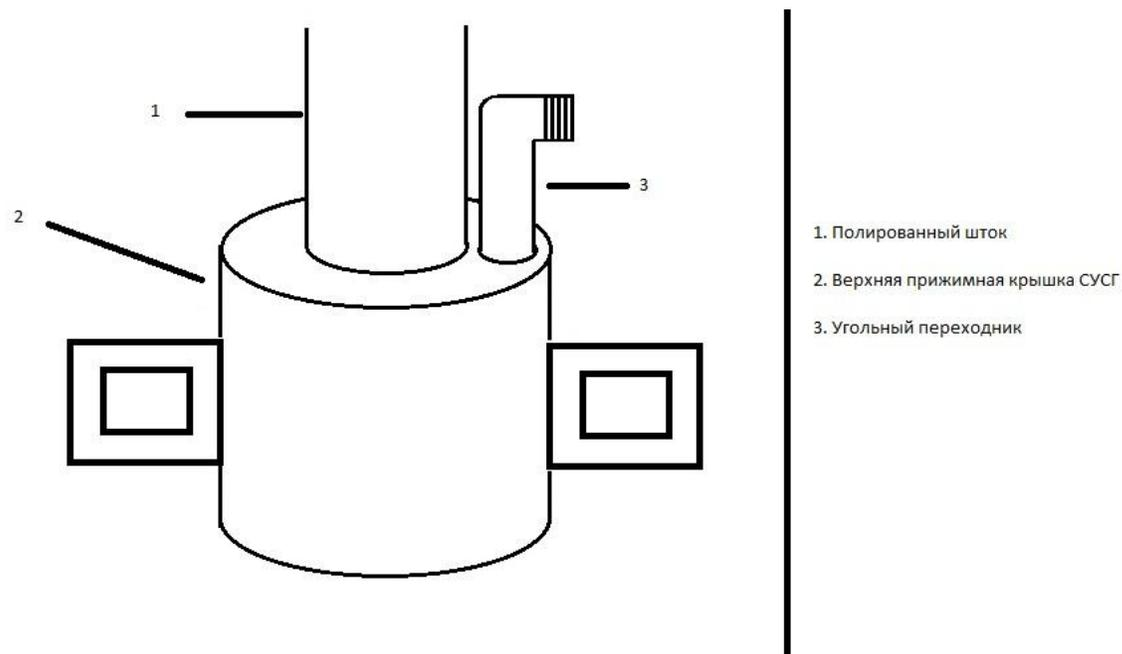
На схеме №2, представлена верхняя прижимная крышка, к которой будет присоединен, угольный переходник. Непосредственно к верхней прижимной крышке, он присоединяется с помощью резьбового соединения, который в свою очередь должен подсоединиться до установки на устье и продевания на полированный шток. Второй ответный конец угольного переходника, предназначен для подсоединения шланга.
