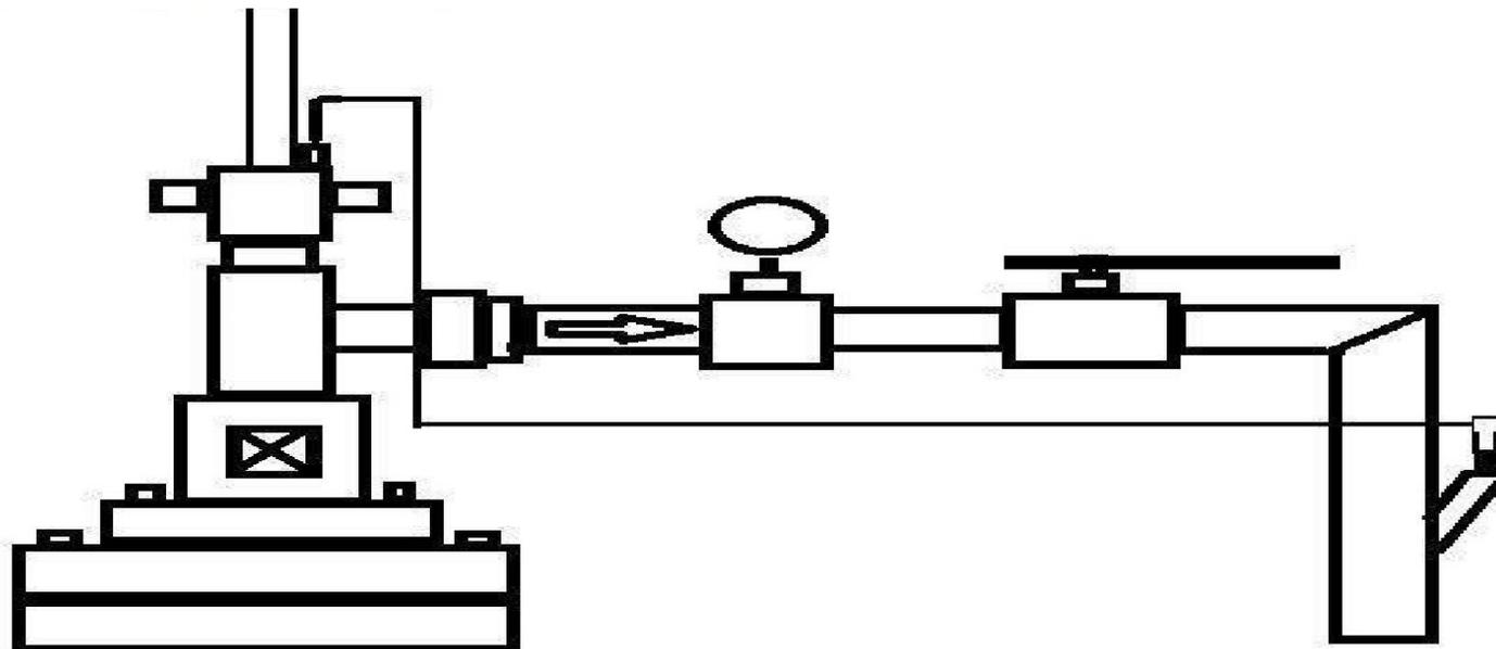
Согласно схеме №1, предлагается использование шланга/трубки подсоединённой к верхней прижимной крышке СУСГ, выход жидкости со шланга можно подсоединить к байпасной системе на выкидной линии или же к емкости, где также отсутствует возможность влияния обратного давления.
