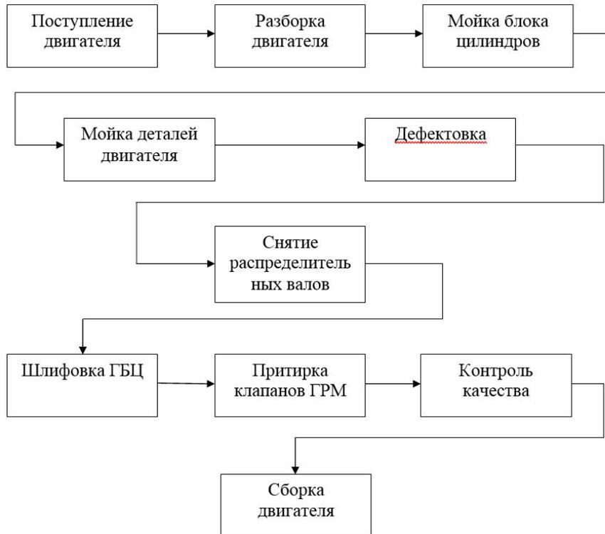
Технологический процесс замены клапанов ГРМ заключается в разборке двигателя с последующей мойкой самого агрегата и его деталей, после чего проводится дефектовка агрегата и его деталей. После дефектовки идет снятие распределительных валов для того чтобы расухарить и снять клапана ГРМ, далее идет шлифовка ГБЦ, затем проводим контроль качества. В конце притирки клапанов ГРМ устанавливаем все детали в порядке, обратном снятию.
