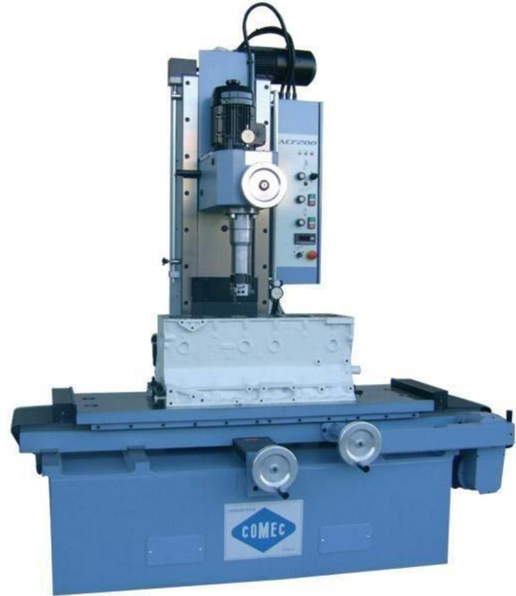
Станок для расточки цилиндров двигателя.
