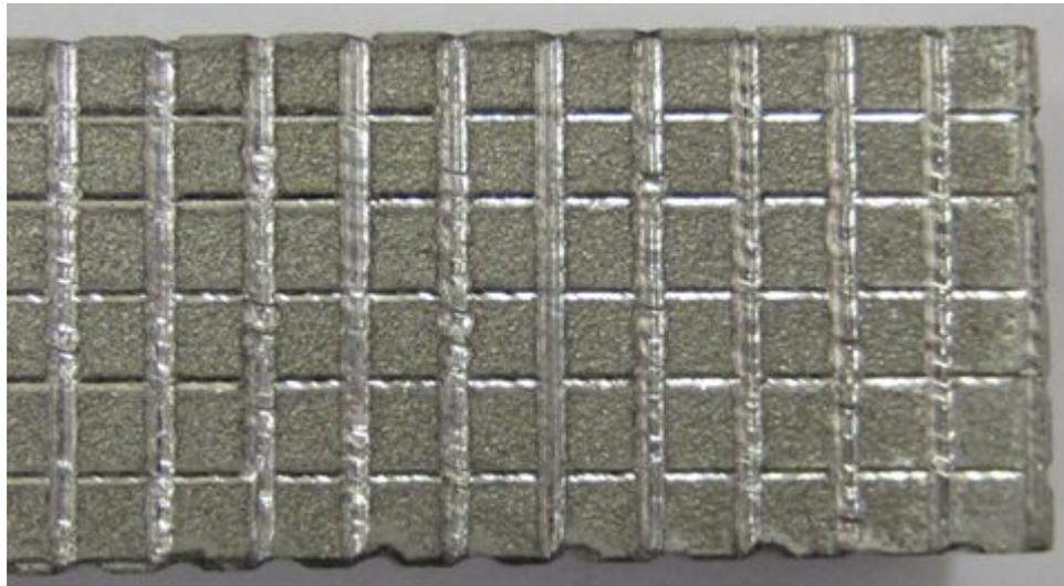
**Материал:** сплав AZ31(96% Mg, 3% Al, 1% Zn, вес. %)
