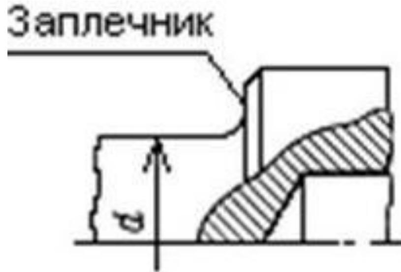
Переходная поверхность от одного сечения к другому, служащая для упора насаживаемых на вал деталей, называется **заплечником**
