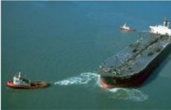
Буксировка судна при помощи буксирных тросов
