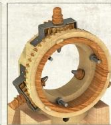
Леонардо да Винчи - Дрель для производство труб с центрирующим зажимным патроном - Кодекс Атлантикус Фолио 1089
