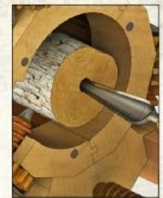
Леонардо да Винчи - Дрель для производство труб с центрирующим зажимным патроном - Кодекс Атлантикус Фолио 1089
