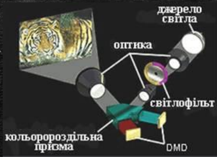
Рис. 10- DLP-система з двома DMD-матрицями
