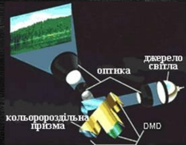
Рис. 11- DLP-система з трьома DMD-матрицями
